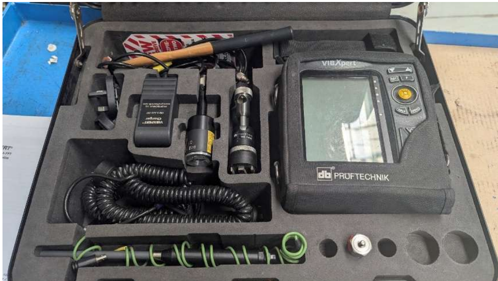
Рисунок 2 — Портативна система для вібромоніторингу Vibxpert виробництва PRUFTECHNIK
