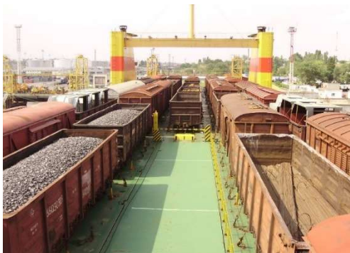
Рисунок 2 — Розміщення напіввагонів, завантажених кам'яним вугіллям, на палубі залізничного порому
