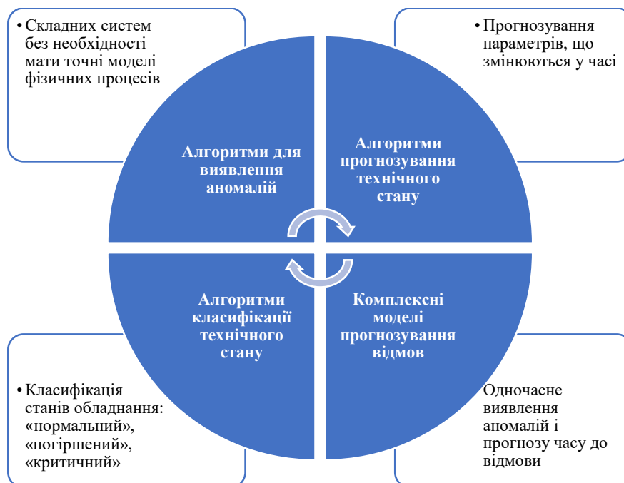
Рисунок 1 — Алгоритми машинного навчання для виявлення відхилень і прогнозування відмов
