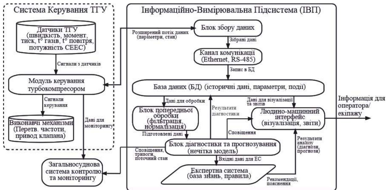
Рисунок 1 — Структурна схема інформаційно-вимірювальної системи моніторингу стану комбінованого турбокомпресора
