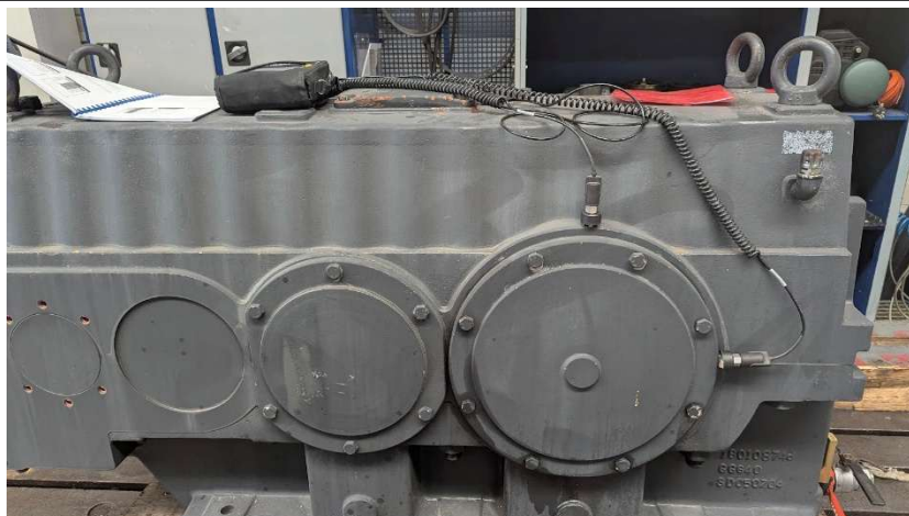
Рисунок 3 — 4-х ступеневий циліндричний редуктор M3PSF90E
