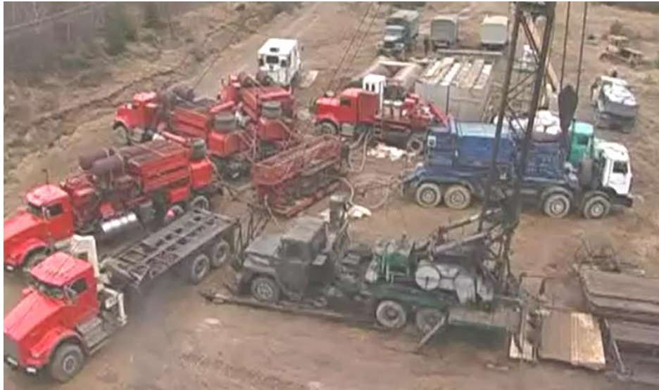
Рисунок 1 — Проведення випробовувань на базі мобільного агрегату для гідророзриву пластів мод. Halliburton Tier IV DGB на шасі Мерседес 4150 (8x8)
