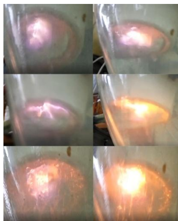
Рисунок 1 – Фото експериментальних наносекундних розрядів в повітряних бульках у воді при її знезараженні
