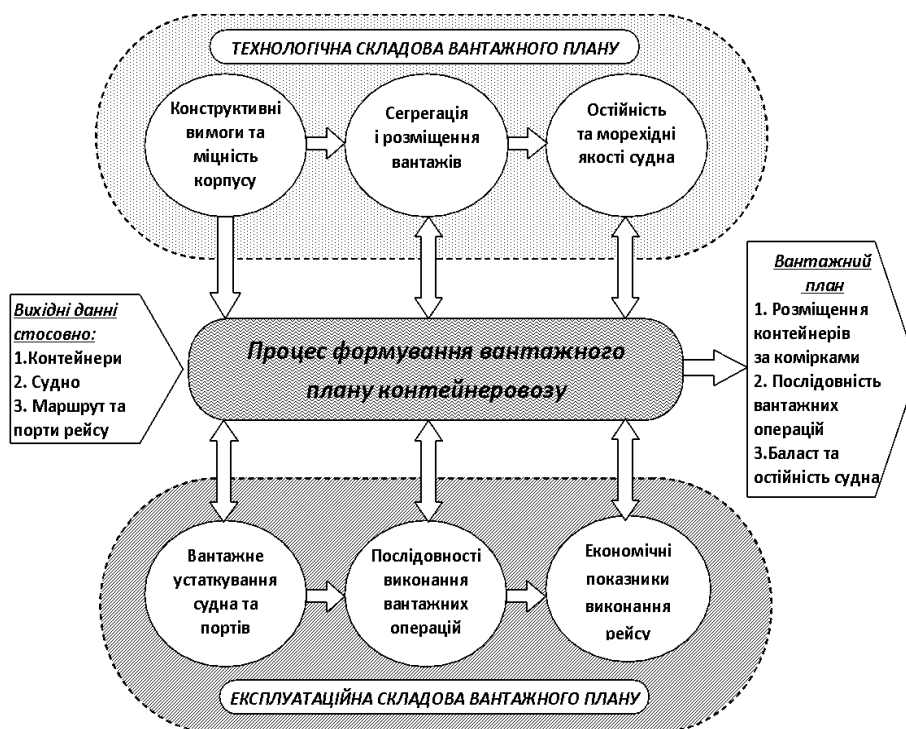
Рисунок 1 — Процес формування вантажного плану контейнеровозу з урахуванням технологічної та експлуатаційної складової [3]
