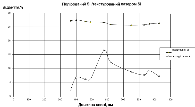
Рисунок 1 — Крива залежності відбиття поверхні від довжини хвилі.
