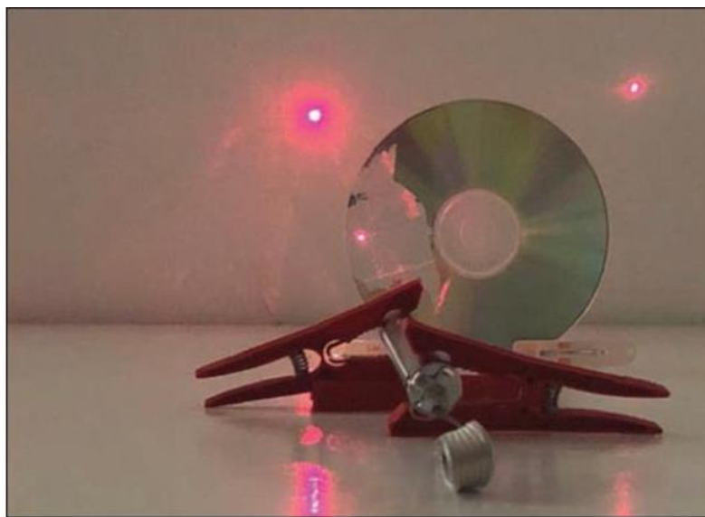
Рисунок 2 – Домашній експеримент: Визначення довжини хвилі світла за допомогою дифракційної решітки [8]
