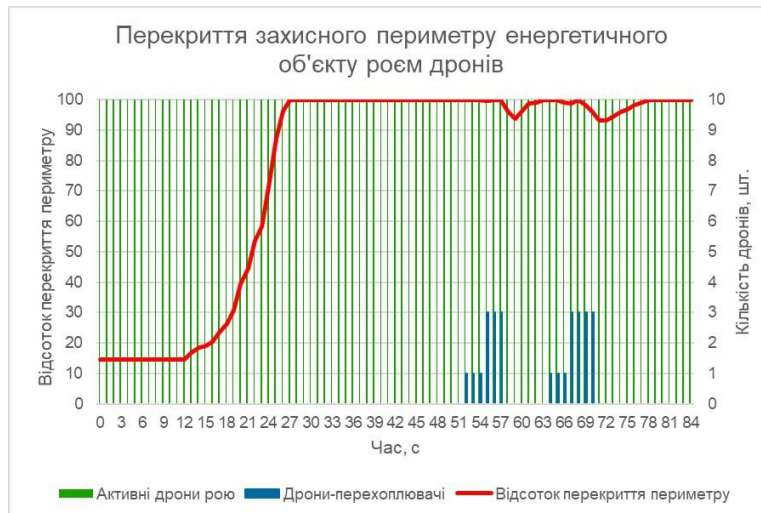
Рисунок 1 — Динаміка перекриття периметру об'єкта роєм дронів
