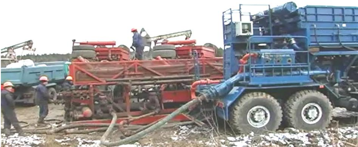
Рисунок 1 — Проведення промислових випробовувань на базі мобільного агрегату для гідравлічного розриву пластів мод. FC-2251
