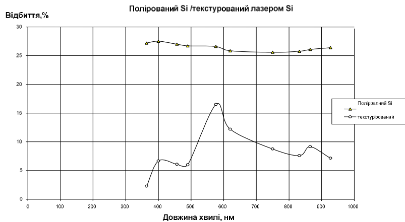
Рисунок 1 — Крива залежності відбиття поверхні від довжини хвилі.
