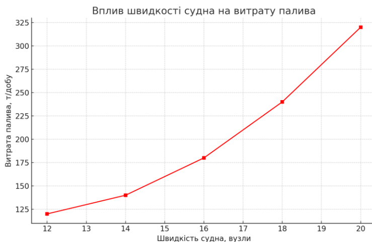
Рисунок 2 — Вплив швидкості судна на витрату палива
