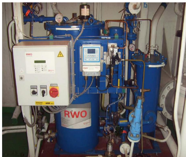
Рисунок 1 — Сепаратор нафтовмістних (ляльних) вод RWO SKIT/S-DEB встановлений на нафтоналивному танкері проекту 550-А
