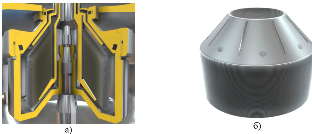
Рисунок 1 — Конструктивні компоненти сепаратора: а — ротор, б — дисковий пакет
