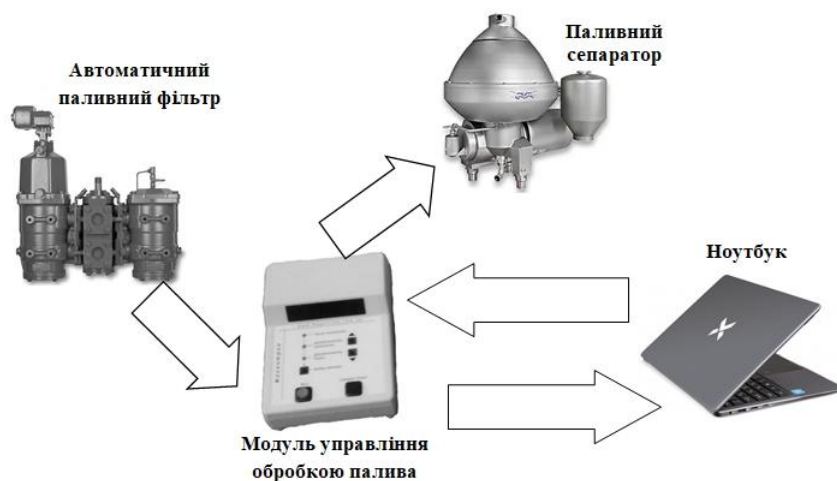
Рисунок 1 — Схема реалізації інформаційної системи контролю очищення палива
