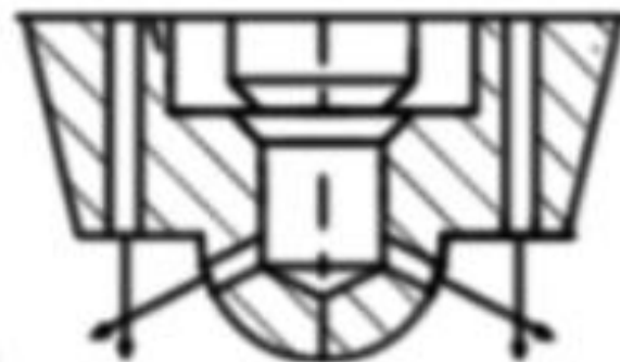
Рисунок 2 — Впорскування палива і подача повітря високого тиску
