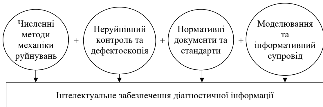
Рис. 1.2 – Структуризація діагностичної інформації технічного стану обладнання
