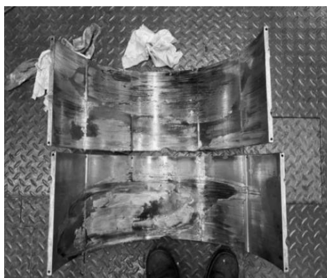
Рис. 3.13 – Дефекти поверхні внутрішньої сторони підшипника
