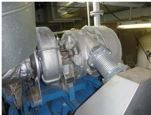
Рис. 3.4 – Турбокомпресор головного двигуна AN B&amp;W L32/40
