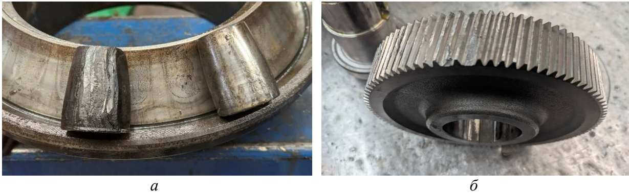
Рисунок 1 — Характерні пошкодження та зноси: а — адгезійний знос тіл кочення підшипника внаслідок порушення умов змащення; б — поломка зубів зубчастого колеса внаслідок роботи редуктору з перевантаженням
