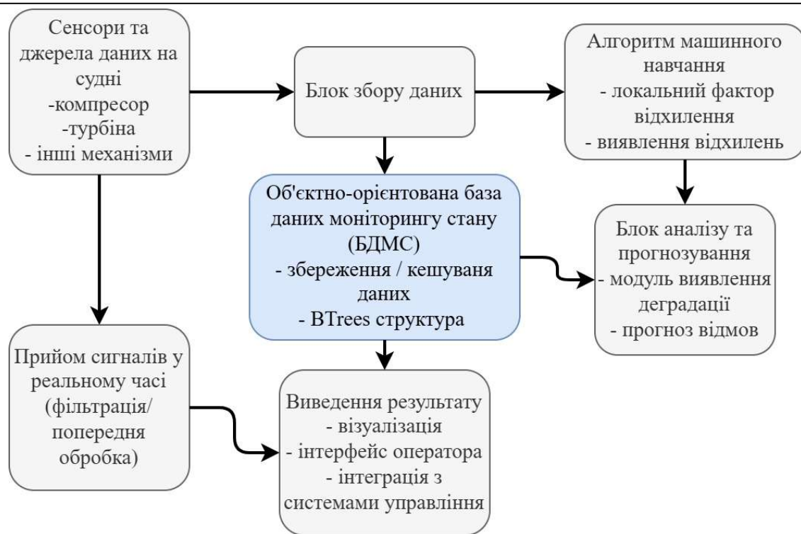
Рисунок 1 — Архітектура системи обслуговування на основі стану ООС
