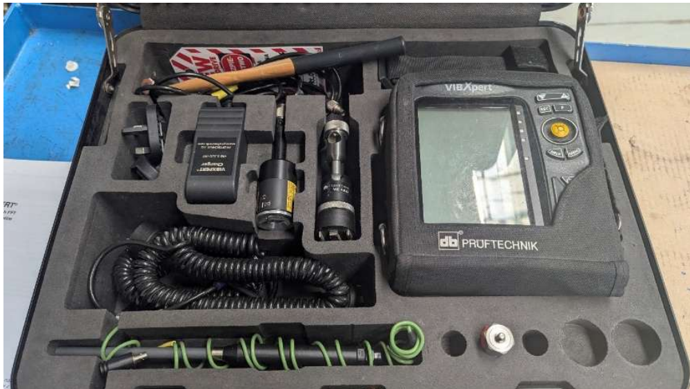
Рисунок 2 — Портативна система для вібромоніторингу Vibxpert виробництва PRUFTECHNIK
