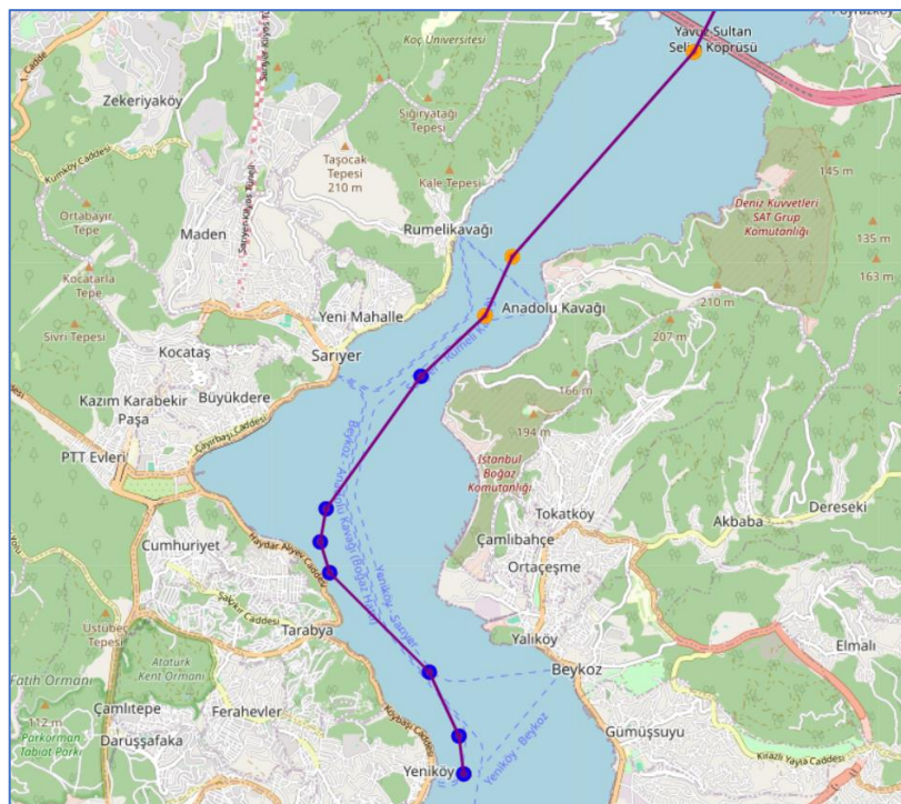
Рисунок 4.13 — Візуалізація функції стискання траєкторії для прискорення обробки даних в режимі реального часу
