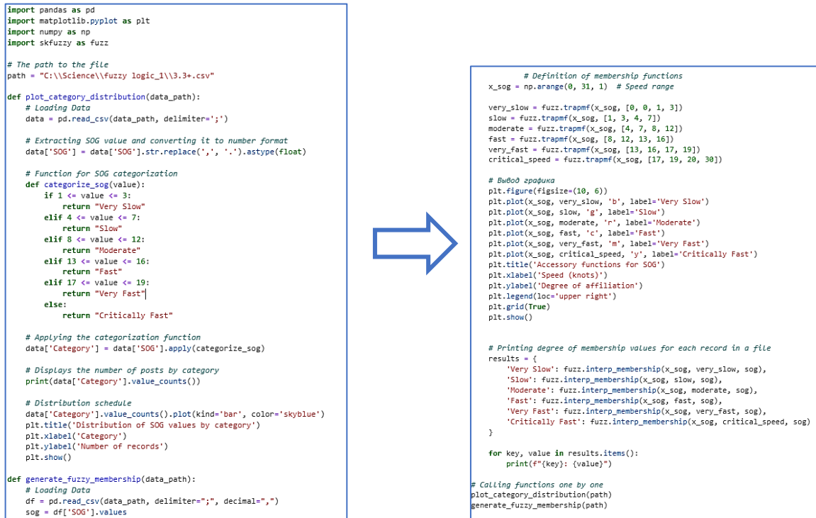
Рисунок 3.3 — Алгоритм обробки експериментальних даних ECDIS
