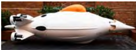
Рисунок 1 – Зовнішній вигляд АНПА з винесеним поза корпус РКП – AUV PingGuin
