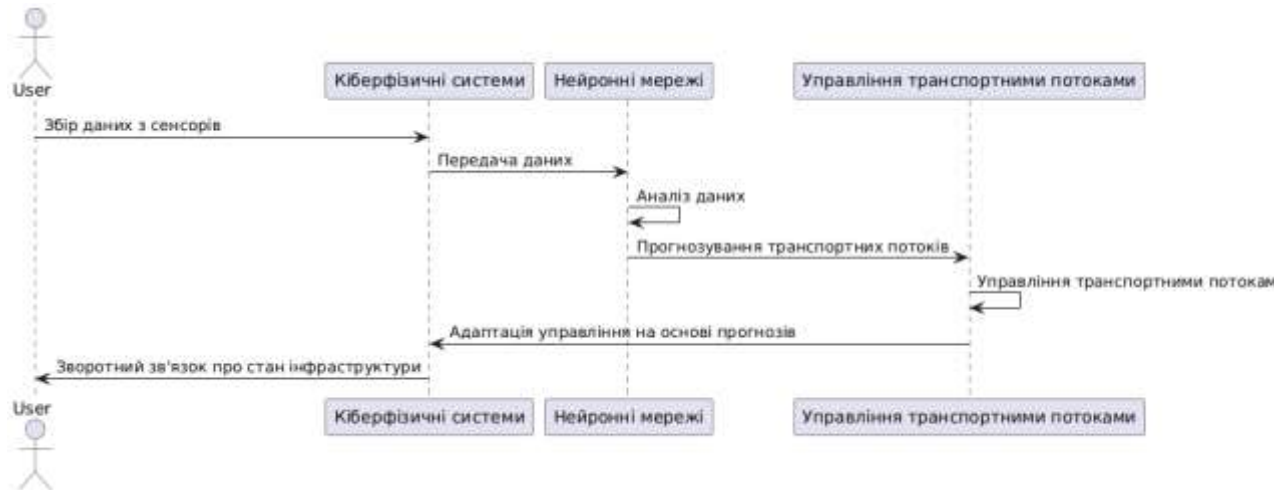
Рис. 1. Схема інтеграції нейронних мереж і кіберфізичних систем для управління транспортними потоками
