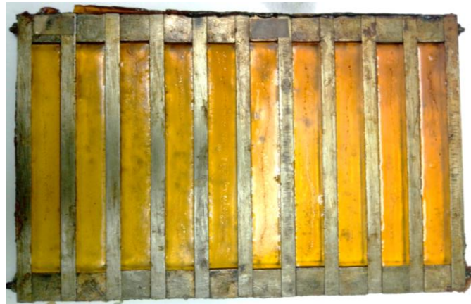
Рисунок 4 – Форма із затверділими зразками для випробувань на 4-х точковий вигин
