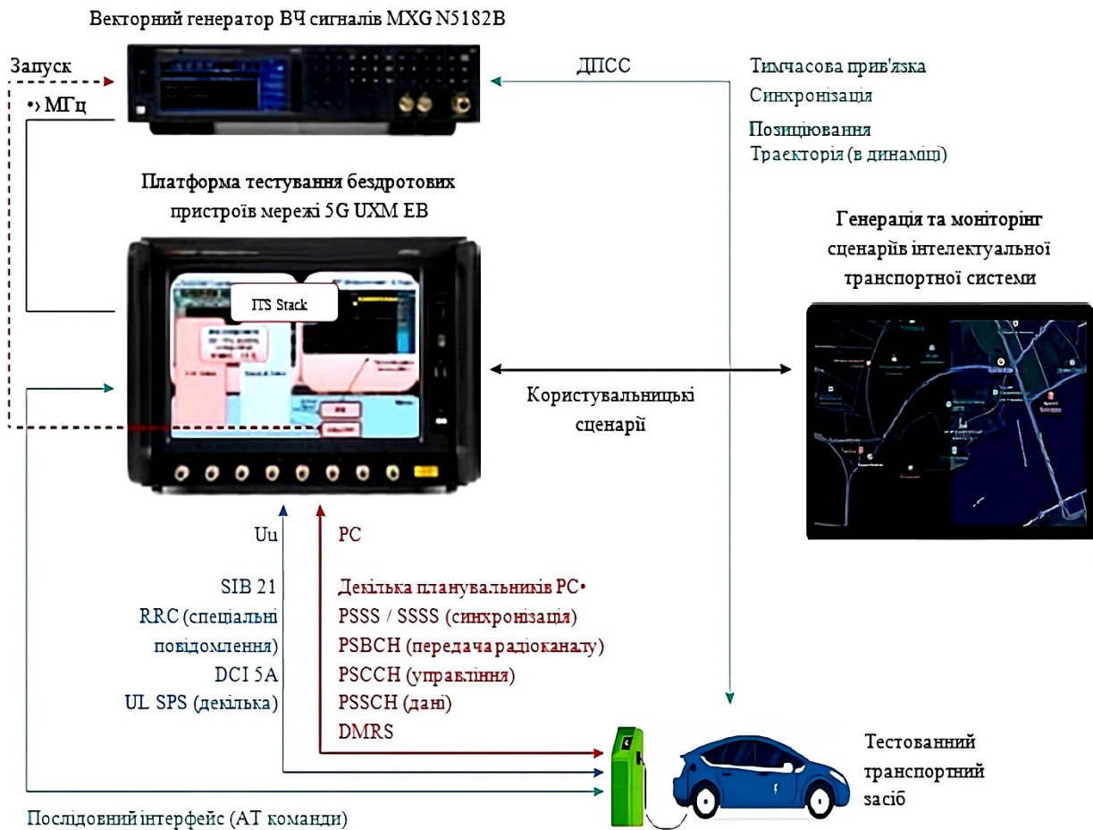
Рисунок 2. Конфігурація для сигнального тестування модуля C-V2X
