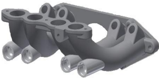
Рисунок 3. 3D модель модернізованого впускного тракту двигуна MeM3-307
