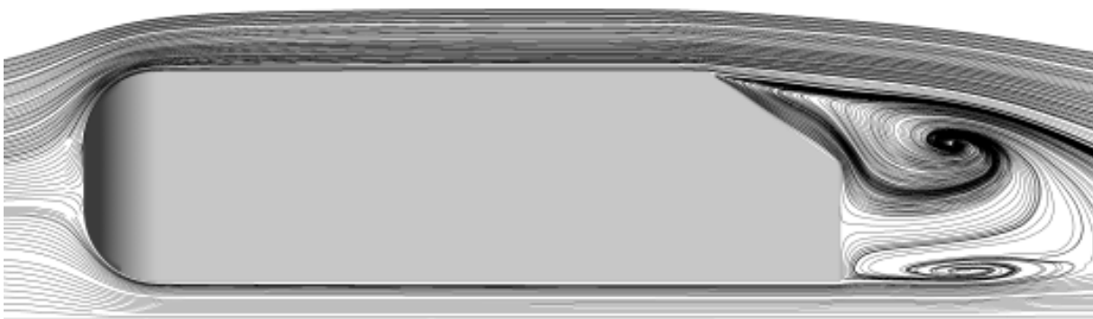
Рисунок 2. Лінії течії в площині симетрії моделі корпусу автомобіля Ahmed Car: а) з кутом нахилу 25^\circ , б) з кутом нахилу 35^\circ
