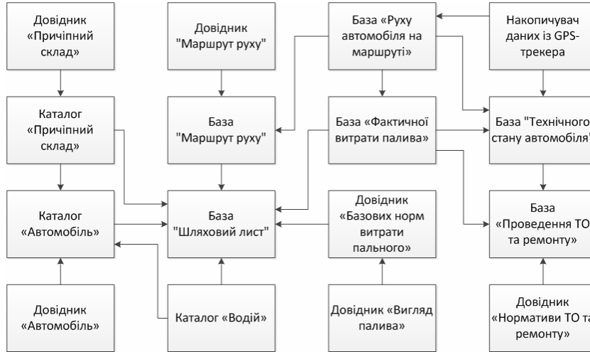
Рисунок 2. Структура бази та схема взаємодії даних для обробки шляхових листів
