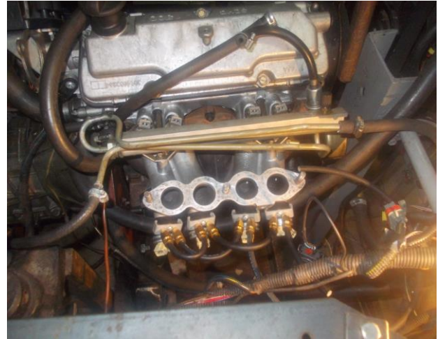
Рисунок 4. Лабораторна установка обладнана модернізованою впускною системою та системою подачі газового палива в рідкому стані
