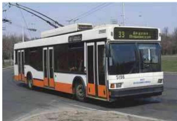
Рисунок 2 – Тролейбус АКSM-221 із тиристорно-імпульсною системою керування тяговими двигунами
