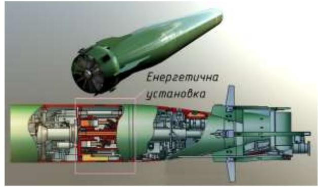
Рисунок 5 – Загальний вигляд і силова установка сучасної торпеди Mark-48 (США) обладнаної аксіально-поршневим двигуном потужністю 370 кВт
