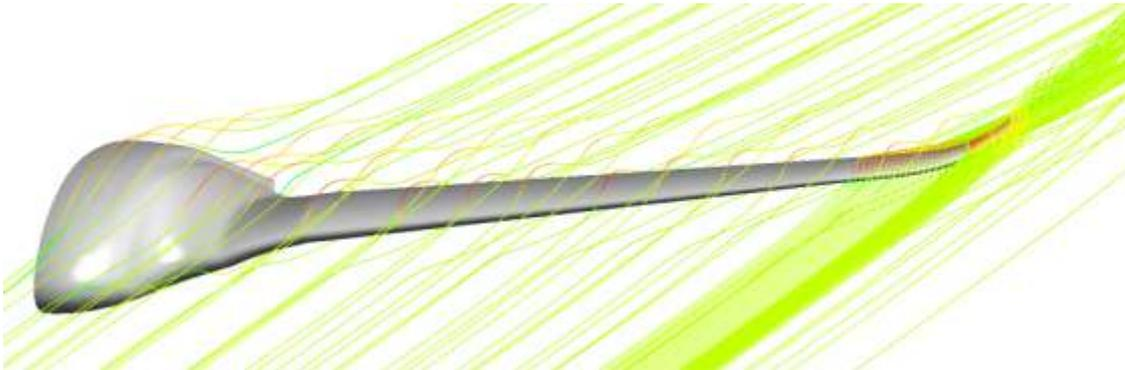
Рисунок 3 – Лінії течії навколо БПЛА при куті установки 2°
