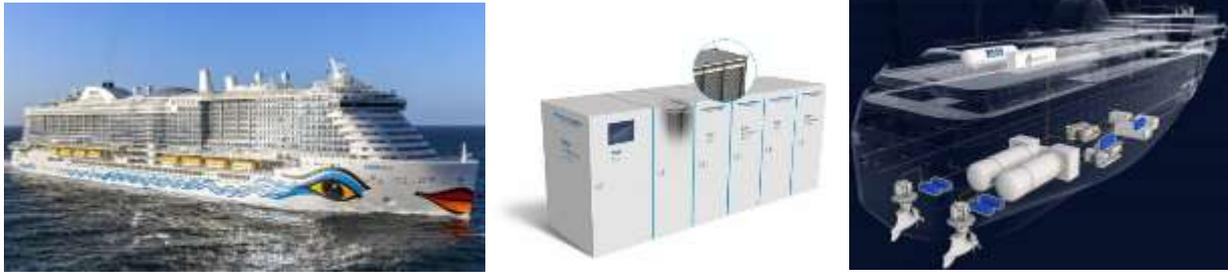
Рисунок 3 – AIDA NOVA перше круїзне судно з гібридною CEU на базі SOFC фірми ТЕКО
