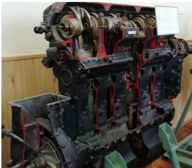
Рисунок 2 – Двигун Jumo-204 у лабораторії кафедри конструкції авіаційних двигунів НАКУ (ХАІ) ім. М.Є. Жуковського (Харків)
