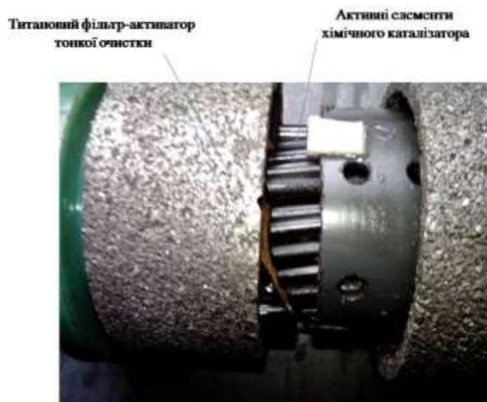
Рисунок 1 – Каталізатор та його елементи
