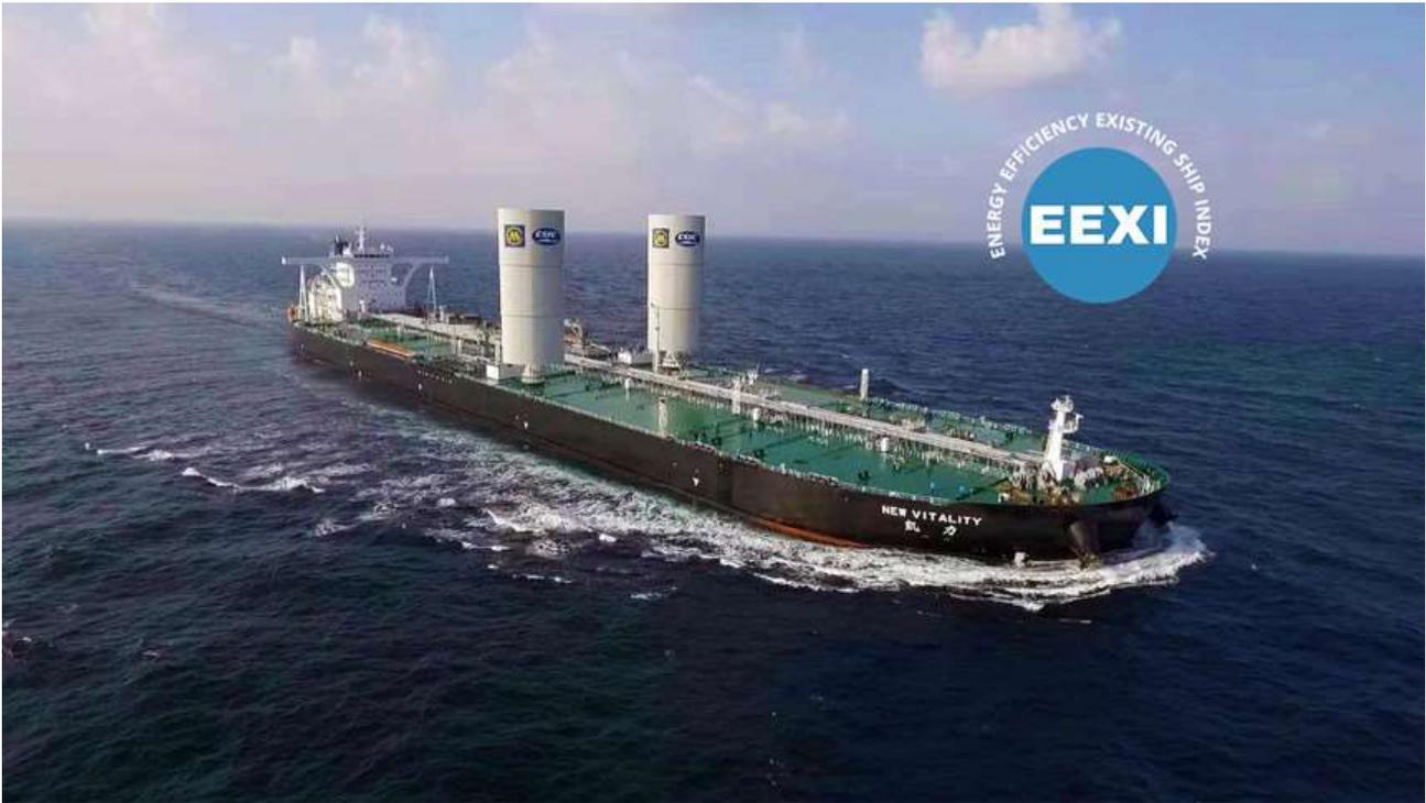
Рисунок 1 – Приклад проекту судна, яке задовольняє вимогам EEXI
