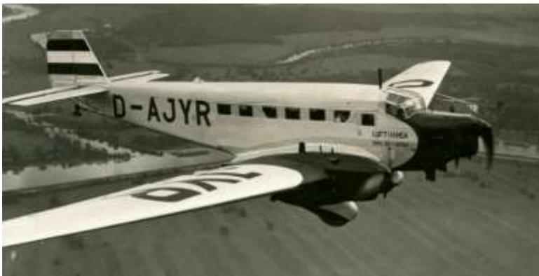
Рисунок 4 – Літак Ju 52/3m з трьома дизельними двигунами JUMO 205 С
