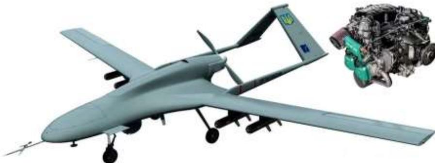
Рисунок 1 – Турецький ударний оперативно-тактичний середньовисотний безпілотний літальний апарат Bayraktar TB2 з двигуном Rotax 912 [1]
