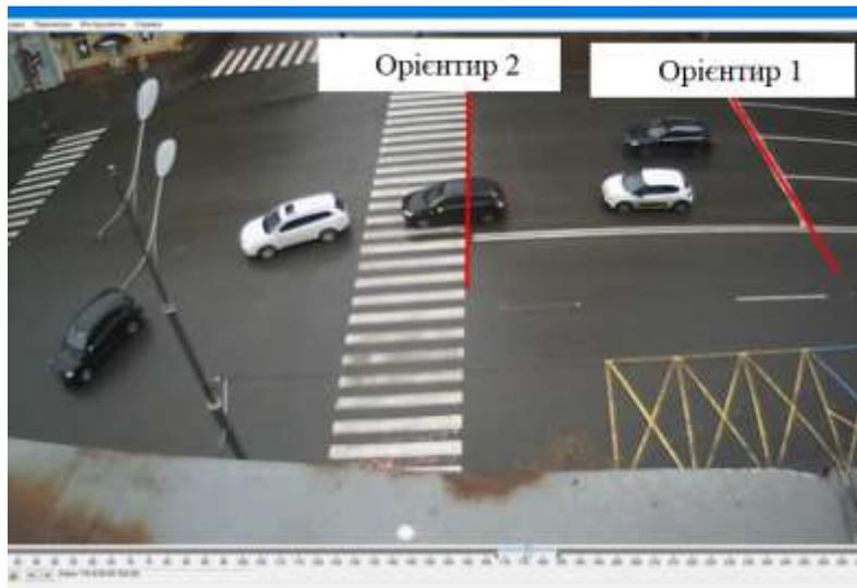
Рисунок 2 – Приклад вимірювання швидкості ТЗ за даними відеоспостереження
