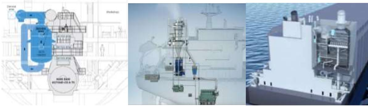
Рисунок 1 – Приклади компоновки обладнання систем очистки скидних газів
