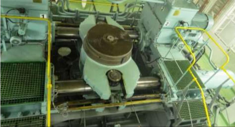
Рисунок 1 – Загальний вигляд рульової машини FLUTEK-KAWASAKI FE 21-243
