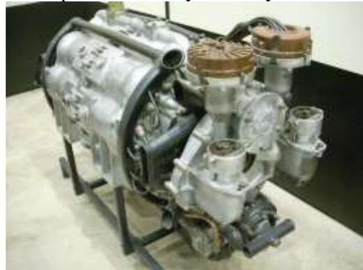
Рисунок 6 – Загальний вигляд 7-циліндрового аксіально-поршневого авіаційного двигуна Almen A-4 фірми Fairdiesel Limited (1911)
