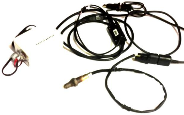
Рисунок 7. Портативна система контролю якості процесу горіння [5]
