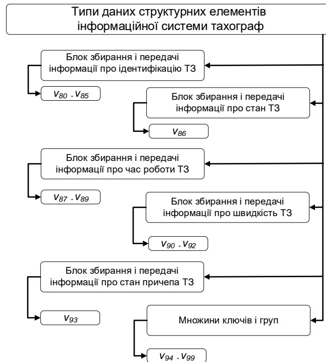
Рис. 1 – Типи даних у блоках структурних елементів інформаційної системи моніторингу параметрів технічного стану ТЗ з встановленим тахографом
