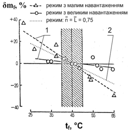
Рис. 3 – Експериментальні дані щодо впливу температури проби t_f на контрольований масовий викид ТЧ m_f : 1 – результати зарубіжних авторів [6]; 2 – результати вітчизняних авторів [10].
