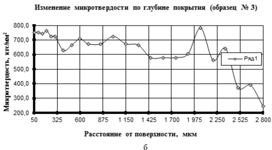
Рис. 5 - Распределение микротвердости электродуговых покрытий из стали 40Х13: а - в исходном состоянии; б - после обработки импульсным ионным азотированием
