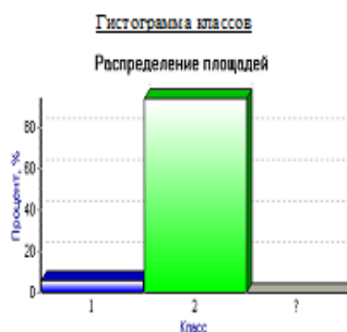
Рис.1 - Распределение пористости в покрытиях, полученных а) электродуговым напылением (ЭДН) и не рекомендуемым к обработке импульсным ионным азотированием (ИИА); б) активированным электродуговым напылением (АДН) и рекомендуемые к обработке ИИА
