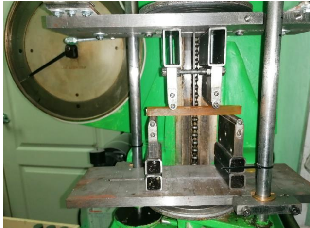
Рис. 2.6. Фото установки для дослідження руйнівного напруження та модуля пружності при згинанні: P – сила навантаження; \Delta L – прогин зразка
