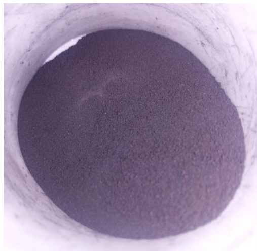
Рис. 2.4. Загальний вигляд сінтезованої порошкової залізо-карбідтитанової шихти
