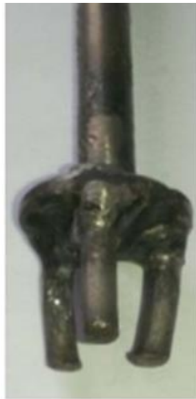
Рис. 2.5 – 3-вістрійна конструкція електродної системи [125]
