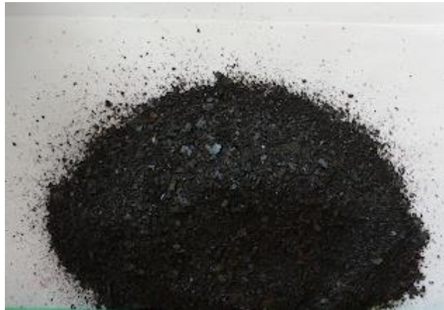
Рис. 2.3. Загальний вигляд прокатної залісної окалини
