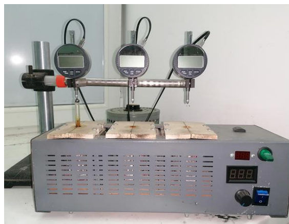
Рис. 2.9. Загальний вигляд установки для дослідження термічного коефіцієнту лінійного розширення
