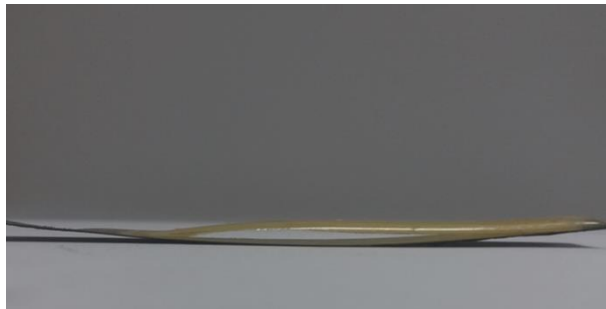
Рис. 3.13. Дефекти покриття зумовлені високими залишковими напруженнями
