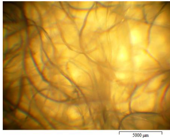
Рис. 2.1. Загальний вигляд суміші дискретних органічних волокон
