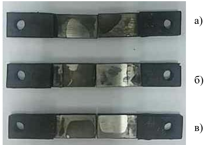
Рис. 3.4. Характер відриву (адгезійна міцність при зсуві) епоксидних композитів із різним вмістом суміші дискретних органічних волокон, q , мас.ч.: а) 0,050; б) 0,100; в) 1,000
