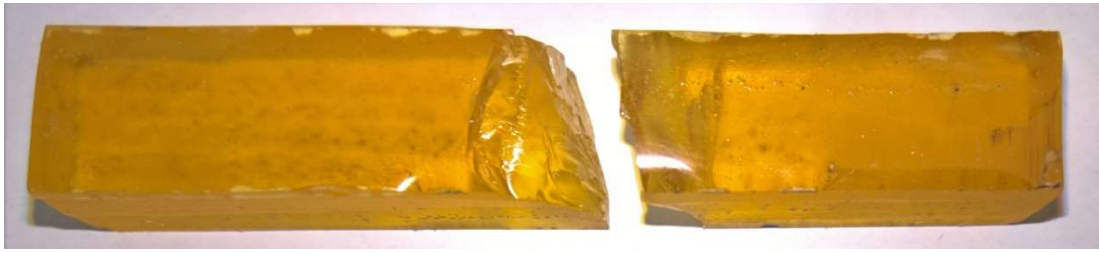
Рис. 3.15. Світлини зламу зразків, модифікованих ДАФМ
