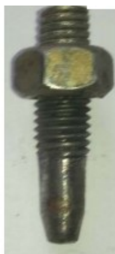
Рис. 2.4. 1-вістрійна конструкція електродних систем [75, 76]
