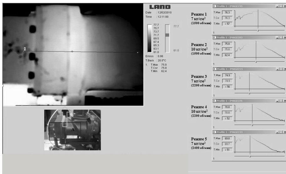
Рисунок 1. Характеристика розподілу температури на поверхні компресору ВК-108Р по термопрофілю 1 в залежності від режиму роботи агрегату
