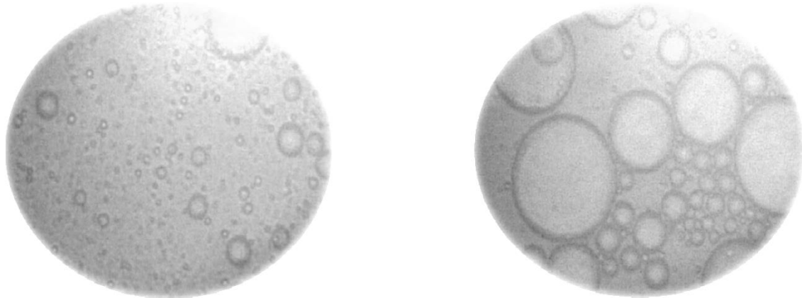
Рисунок 3. Зміна структури ВПЕ в залежності від діаметра пор мембрани (зліва – 0,2 мкм, праворуч – 0,45 мкм) при однаковому вмісті води ( V_e \approx 17\% ) та емульгатора (0,5% Span-80 і Твін-60); ширина кадру – 130 мкм
