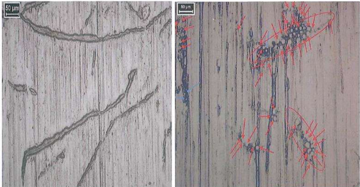
Рисунок 7 – Абразивный износ цилиндровой втулки по причине присутствия алюмосиликатов (Cat Fines) в топливе
