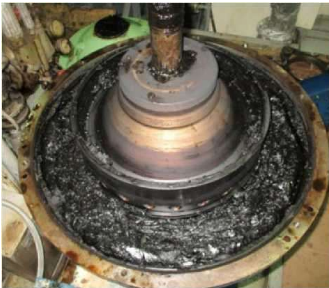
Рисунок 5 – Парафиновые отложения в топливном сепараторе
