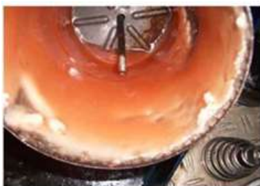
Рисунок 4 – Парафиновые отложения в топливном фильтре
