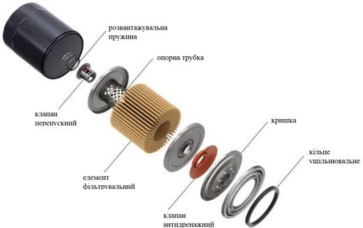
Рисунок 1 – Конструкція масляного фільтра баночного типу
