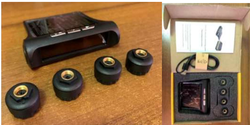
Рисунок 1 – Система контролю внутрішнього тиску і температури з зовнішніми датчиками
