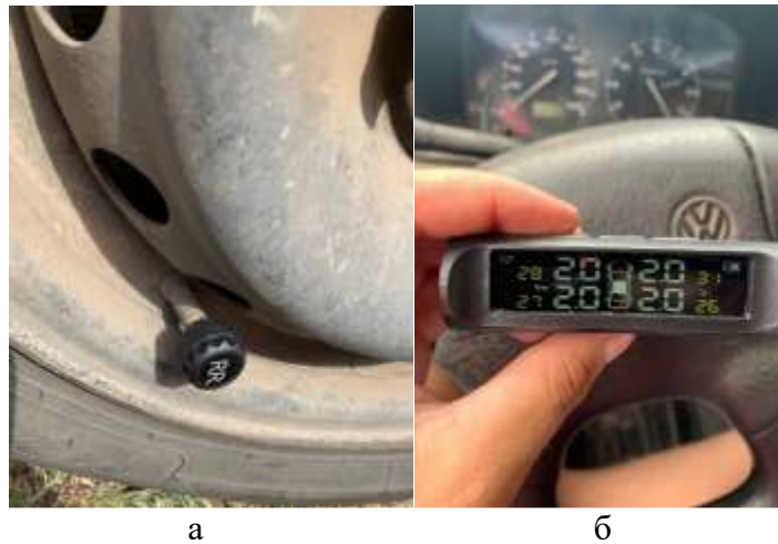
Рисунок 3 – Закріплений датчик тиску та температури та показники значень тиску в шинах на початку експерименту
