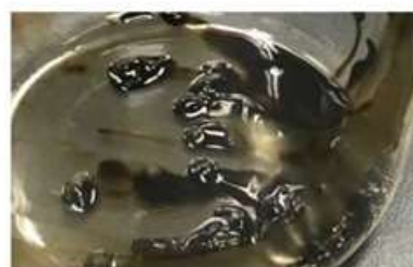
Рисунок 4 – Парафиновые отложения в топливном фильтре
