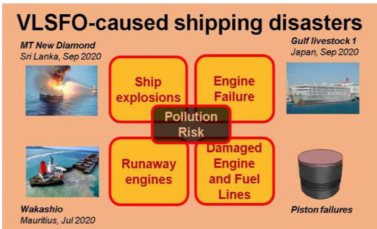
Рисунок 1 – Аварии на судах в 2020 году по причине использования топлива с содержанием серы менее 0,5%
