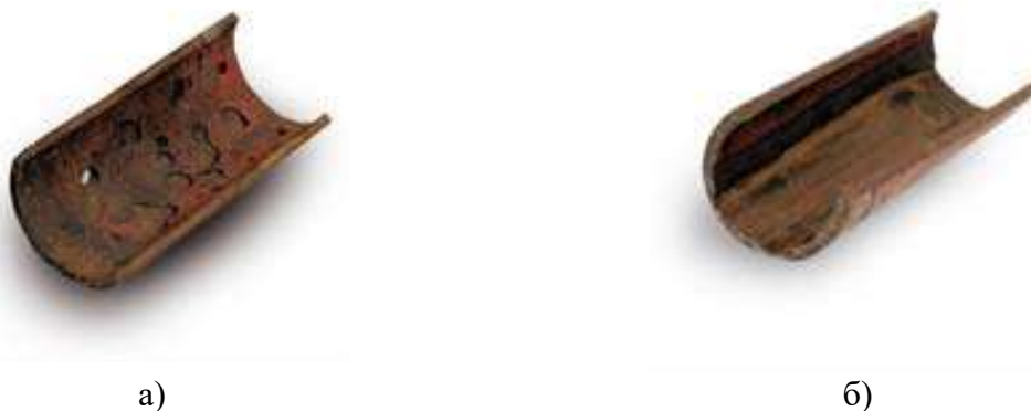
Рисунок 3 – Вплив корозійних процесів на стан трубопроводу: а – парова система; б – система з органічним теплоносієм [1]
