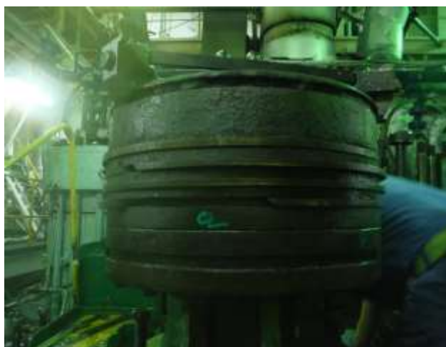
Рисунок 8 – Состояние поршня судового двигателя после 240 часов работы на низкосернистом топливе
