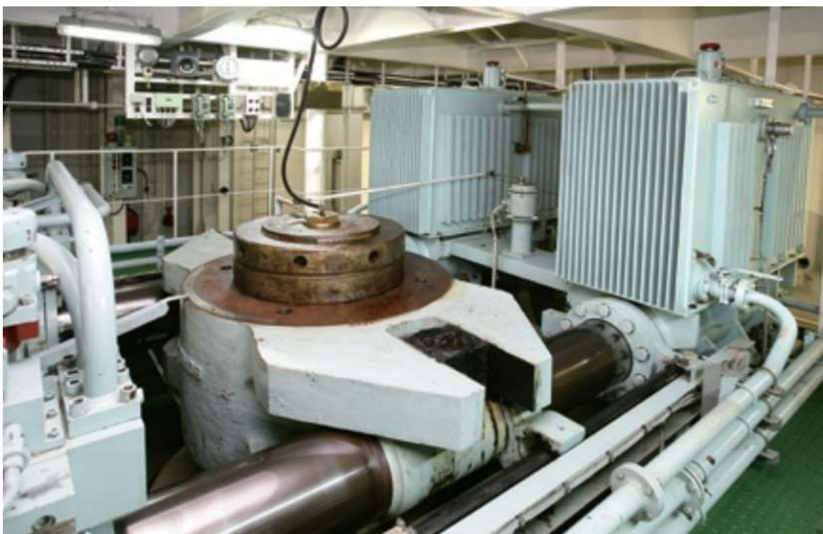
Рисунок 5 – Загальний вид механізму рульової машини YOOWON-MITSUBISHI YDFT-335-2
