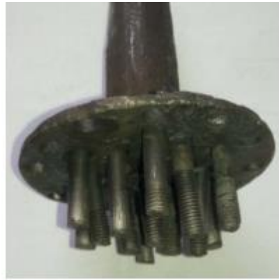
Рис. 2.4. 15-вістрійна конструкція електродної системи [147].
