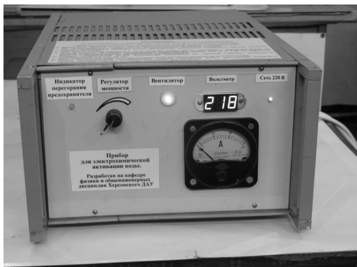
Рисунок 1 – Блок управління процесом електрохімічної активації води
