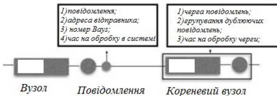
Рисунок 5 – Елементи моделі бездротової мережі контейнеровозу
