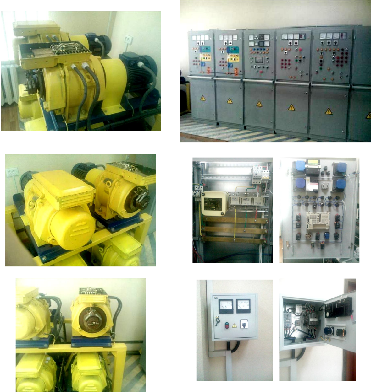
Рисунок 3 – Апаратна модель суднової електростанції на черговому етапі монтажу
