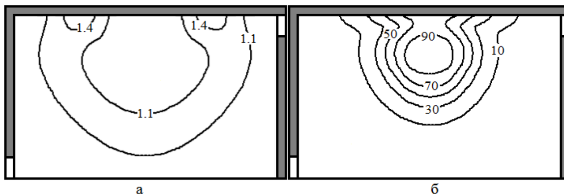
Рисунок 8 – Поля параметров потока в случае взрыва в момент времени \tau = 12,01 с: а – давления (атм), \tau = 12,012 с; б – вероятности разрыва барабанных перепонок (%)
