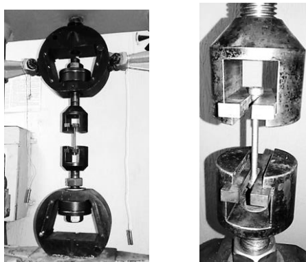
Рисунок 2 – Реновация универсальной испытательной машины УМ-5 под вилочные захваты на шаровых шарнирах (ХГМА НИЛ «Полимерные композитные материалы в судостроении»)
