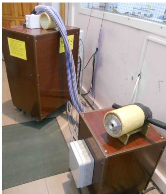
Рисунок 1 – Экспериментальный комплекс бесконтактной магнитно-импульсной рихтовки
