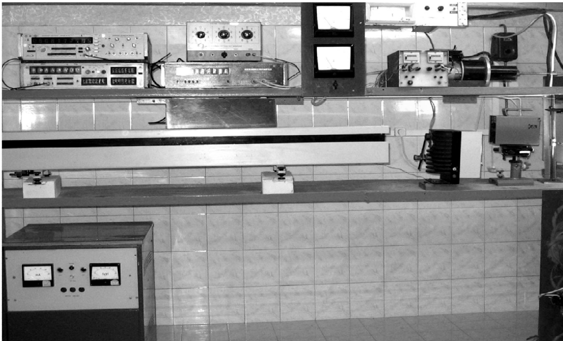
Рисунок 1 – Общий вид экспериментальной установки для исследования горючесть различного рода преград (материалов) на пути лучистого потока лазера
