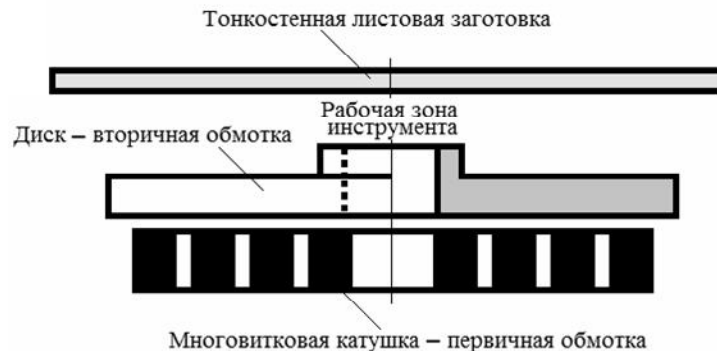
Рисунок 1 – Схематическое изображение совмещённого согласующего устройства дискового типа
