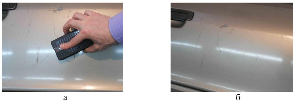
Рисунок 5 – Окончание процесса магнитно-импульсной рихтовки: а – удаление маркерных обозначений; б – элемент кузова автомобиля после рихтовки
