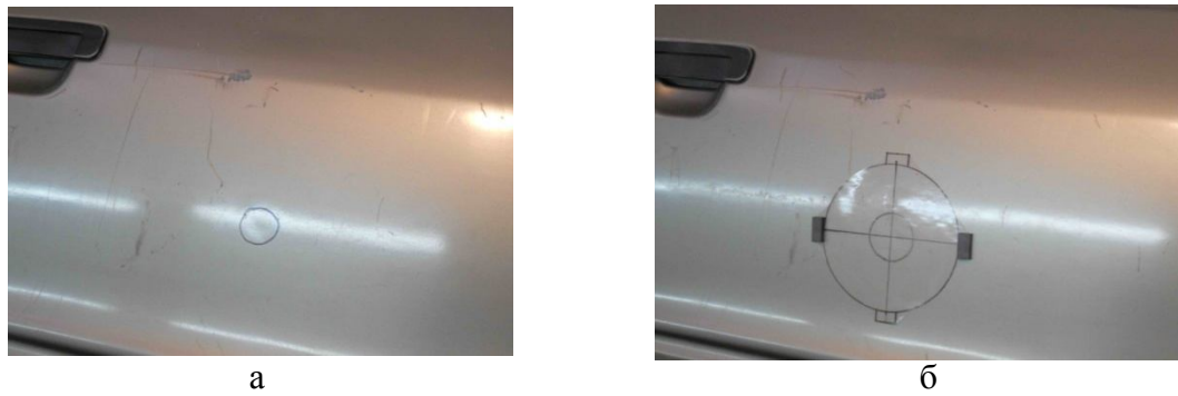
Рисунок 3 – Фиксация вмятины на панели двери автомобиля «Ауди»: а – определение граничных размеров; б – размещение над вмятиной диэлектрической наклейки
