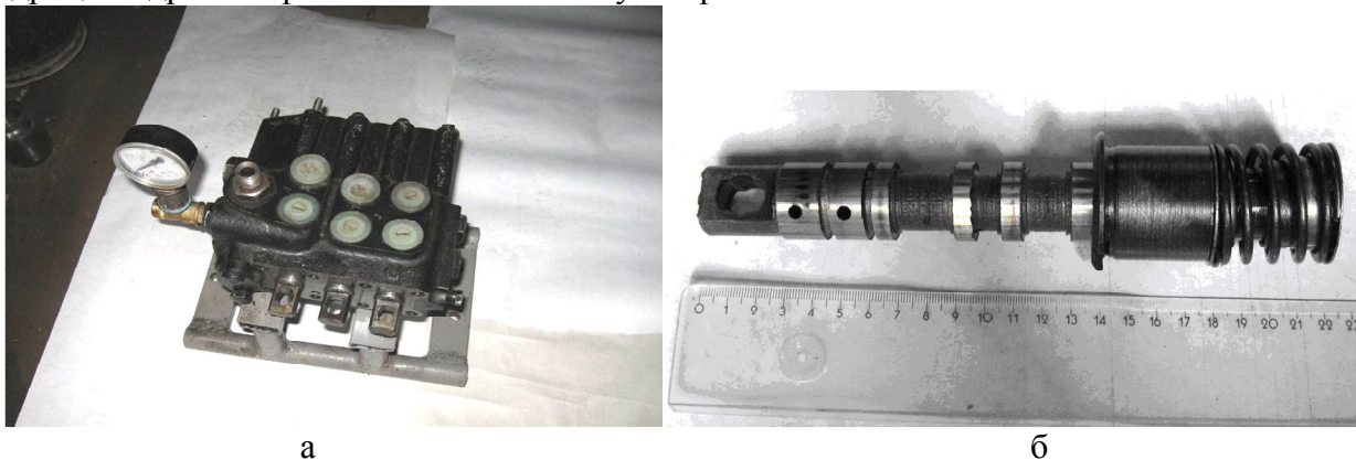
Рисунок 2 – Гідророзподільник бортової системи привода (а) та його золотник (б)
