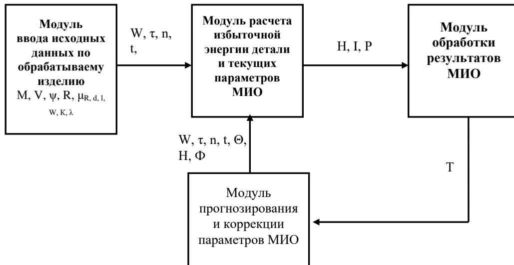
Рисунок 2 – Структура интеллектуальной системы управления процессом МИО
