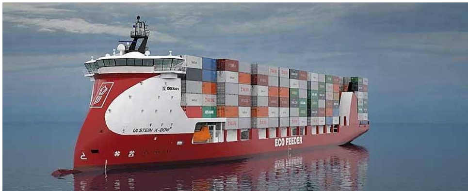
Рисунок 8 – Контейнеровоз концепції «X-Bow» проекту DX541
