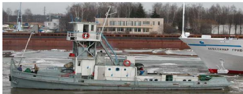
Рисунок 11 – Буксирный теплоход-газоход типа «447» мощностью 300 э.л.с., 1942г.
