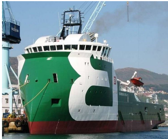
Рисунок 6 – «Bourbon Orca» – перше судно компанії «Ulstein», побудоване за інноваційною технологією «X-Bow»
