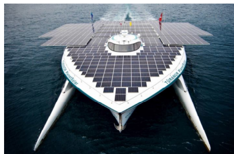
Рисунок 5 – Найбільше в світі судно, що працює на сонячних батареях – проект «Planet Solar Türanor»
