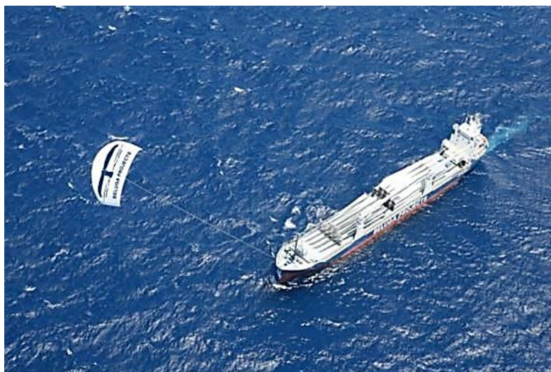
Рисунок 9 – Суховантажник «MS Beluga SkySails» із встановленою системою «SkySails»
