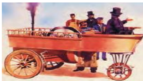
Рисунок 2 – Омнибус Ленуара с газогенераторным двигателем
