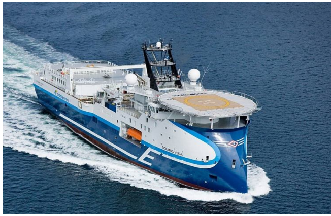
Рисунок 7 – Судно «Oceanic Vega» компанії «Ulstein», побудоване за інноваційною технологією «X-Bow»
