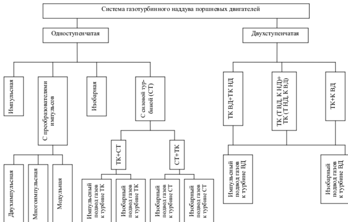
Рисунок 1 – Иерархическая схема различных систем газотурбинного наддува поршневых двигателей
