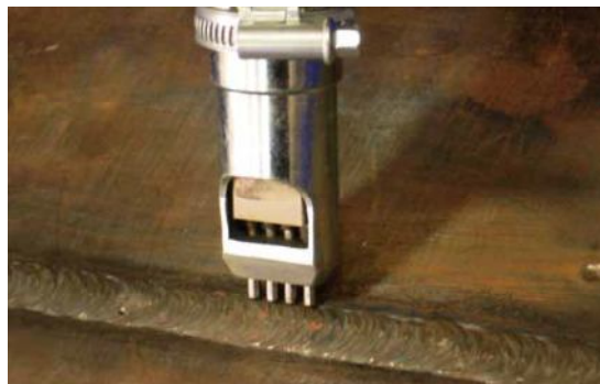
Рисунок 1 – Ультразвуковая ударная обработка
