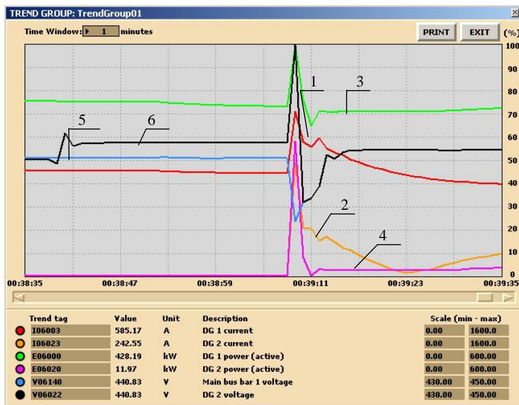
Рисунок 4 – Осциллограмма параметров генераторов при синхронизации перевозбужденного генератора G2 с сетью
