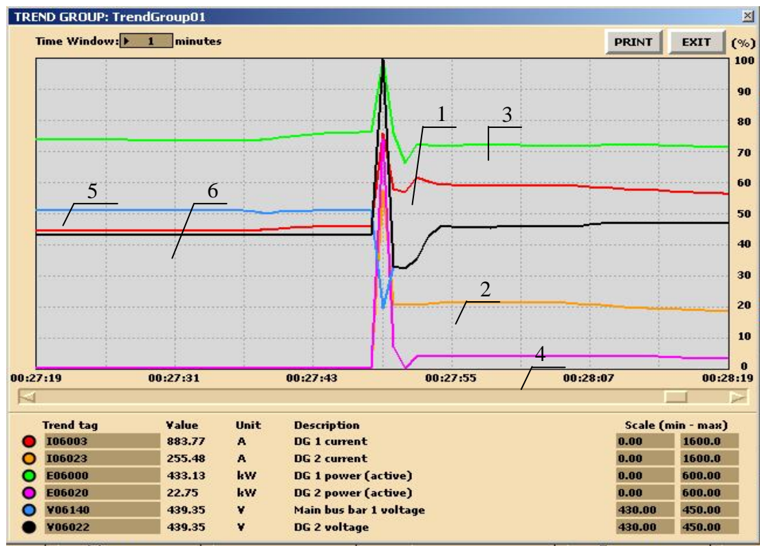
Рисунок 3 – Осциллограмма параметров генераторов при синхронизации недовозбужденного генератора G2 с сетью
