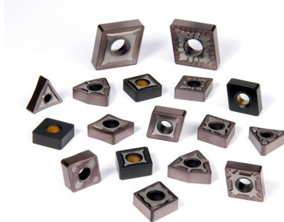
Рисунок 1 – Твердосплавні пластинки зі стружколамаючими канавками, кріпленням і зміцнювальними покриттями для операції точіння, розточування, фрезерування, свердління, нарізування різьблення, прорізання канавок і відрізання канавок і відрізання заготівель
