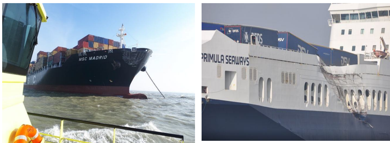
Рисунок 2 – Повреждения, нанесенные судам в результате столкновения
