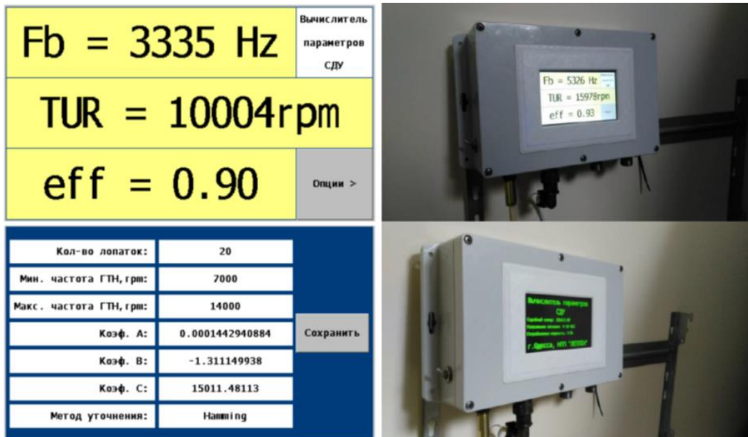
Рисунок 1. Вычислитель параметров СДУ (рабочий экран и экран настроек)
