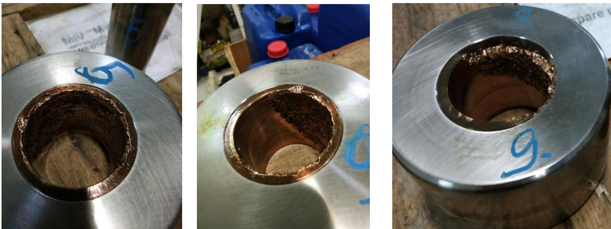
Рисунок 1. Фотографії роликів приводу ПНВТ зі зруйнованими підшипниковими втулками
