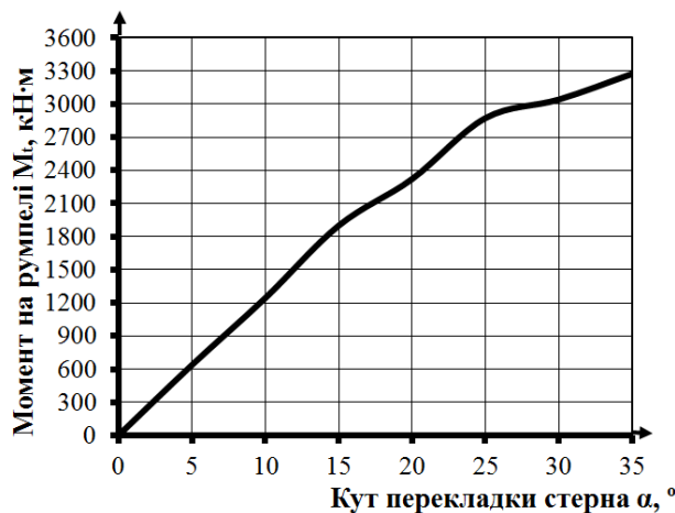
Рисунок 2. Графік залежності моменту на румпелі від кута перекидання стерна
