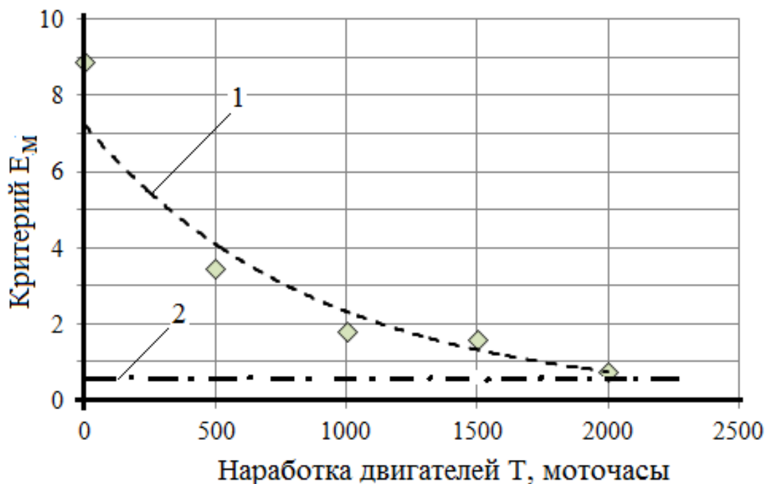
Рисунок 1. Динамика изменения критерия E_M от наработки газопоршневых двигателей: 1 – текущие значения; 2 – критическое значение
