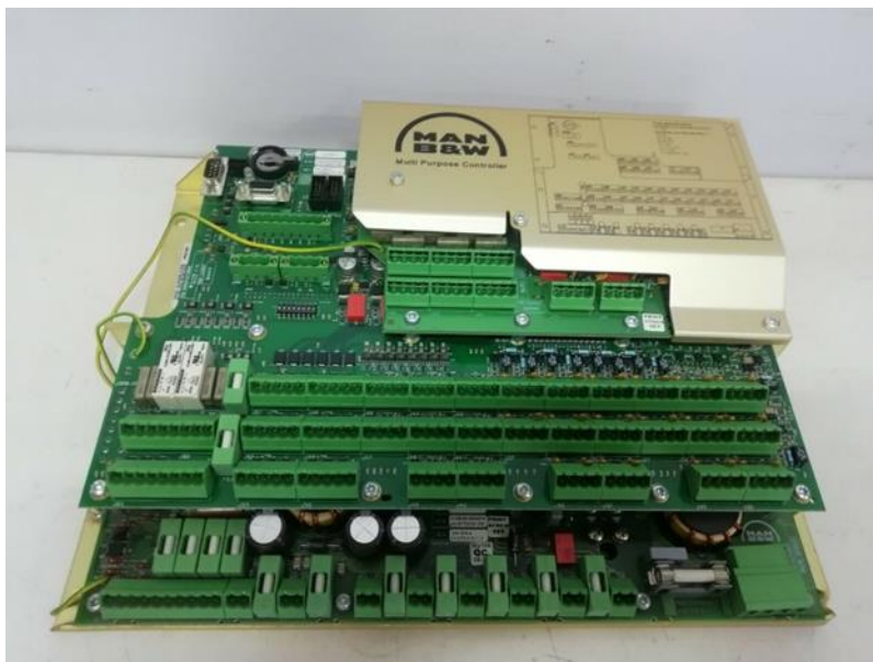
Рисунок 3. Внешний вид универсального блока управления MAN B&W Diesel MPC Module 1142075-2 REV 1.62
