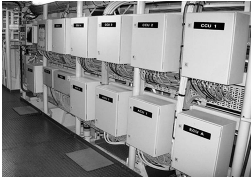
Рисунок 2. Компонировка блоков системы управления двигателя ME в машинном отделении судна
