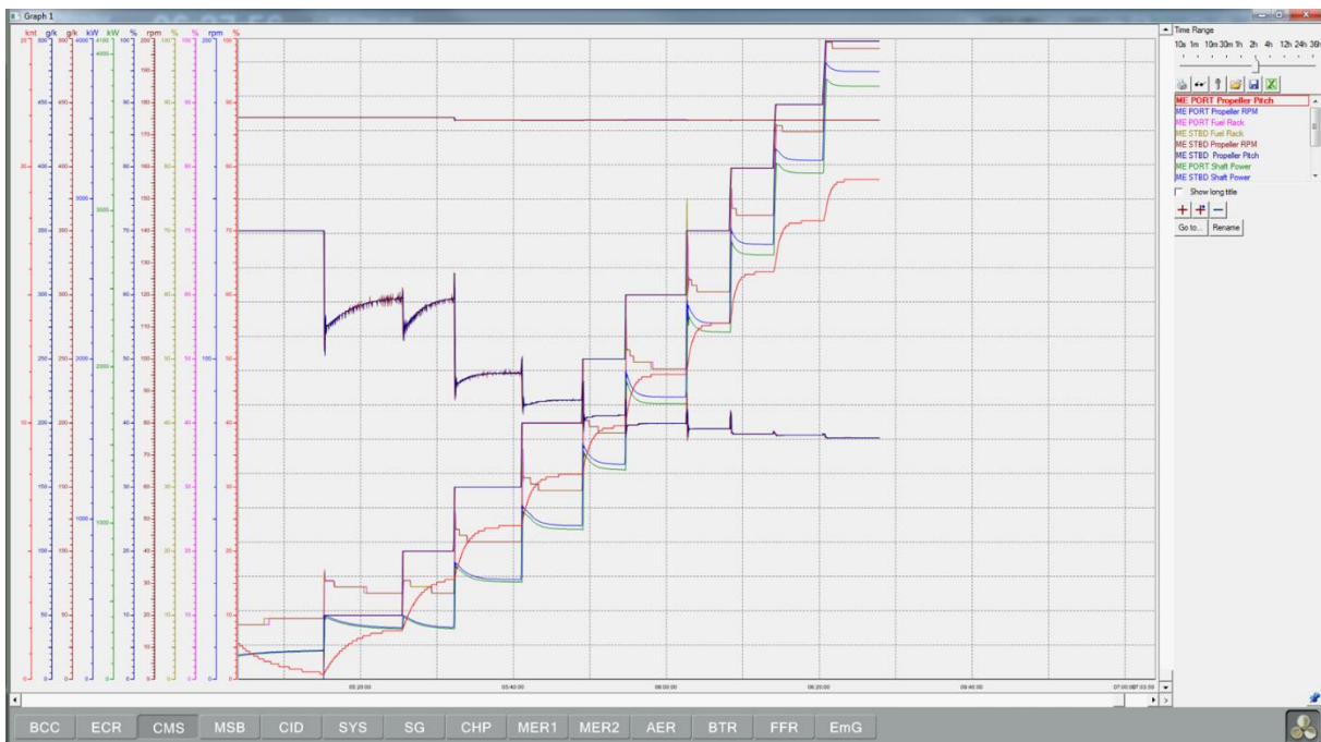
Рисунок 3. Графічне зображення параметрів ГД, що працюють на ГРК від часу, необхідних для побудови регуляторної характеристики
