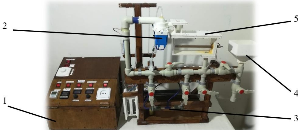
Рисунок 1. Общий вид стенда: 1 – пульт управления, 2 – циркуляционный насос, 3 – разрядник, 4 – вискозиметр, 5 – ёмкость с топливом
