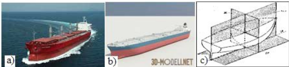
Рисунок 1. Суховантажне судно: а) загальний вигляд; б) 3D модель; с) площини, що ділять судно
