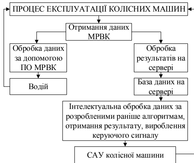
Рисунок 3. Схема функціонування реєстраційно-вимірювального комплексу з елементами штучного інтелекту
