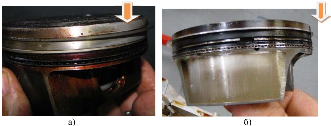
Рисунок 7. Односторонняя потертость жарового пояса поршня (а) вызвана перекопом из-за эксплуатационной или ремонтной деформации шатуна, в то время как небольшие 2-сторонние потертости (б) являются признаком качания поршня в цилиндре из-за возможных изгибных колебаний шатуна при работе на высоких частотах вращения
