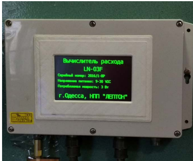
Рисунок 2. Виброакустический модуль LN-03F производства НПП «ЛЕПТОН»
