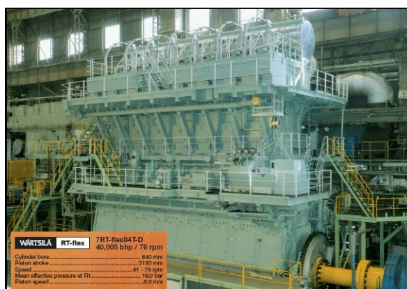
Рисунок 2. Сучасний судновий ДВЗ WARTSILA 7RT-flex 84T-D потужністю 40 тис. кінських сил, або 29,4 МВт і його габарити
