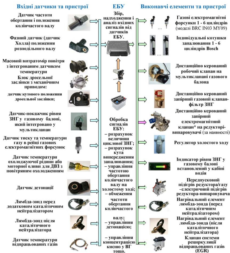
Рисунок 2. Загальна схема системи електронного управління газовим 6-ти циліндровим ДВЗ з примусовим запалюванням для роботи на ЗНГ
