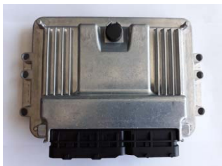
Рисунок 3. Зовнішній вигляд ЕБУ Avenir Gaz 37
