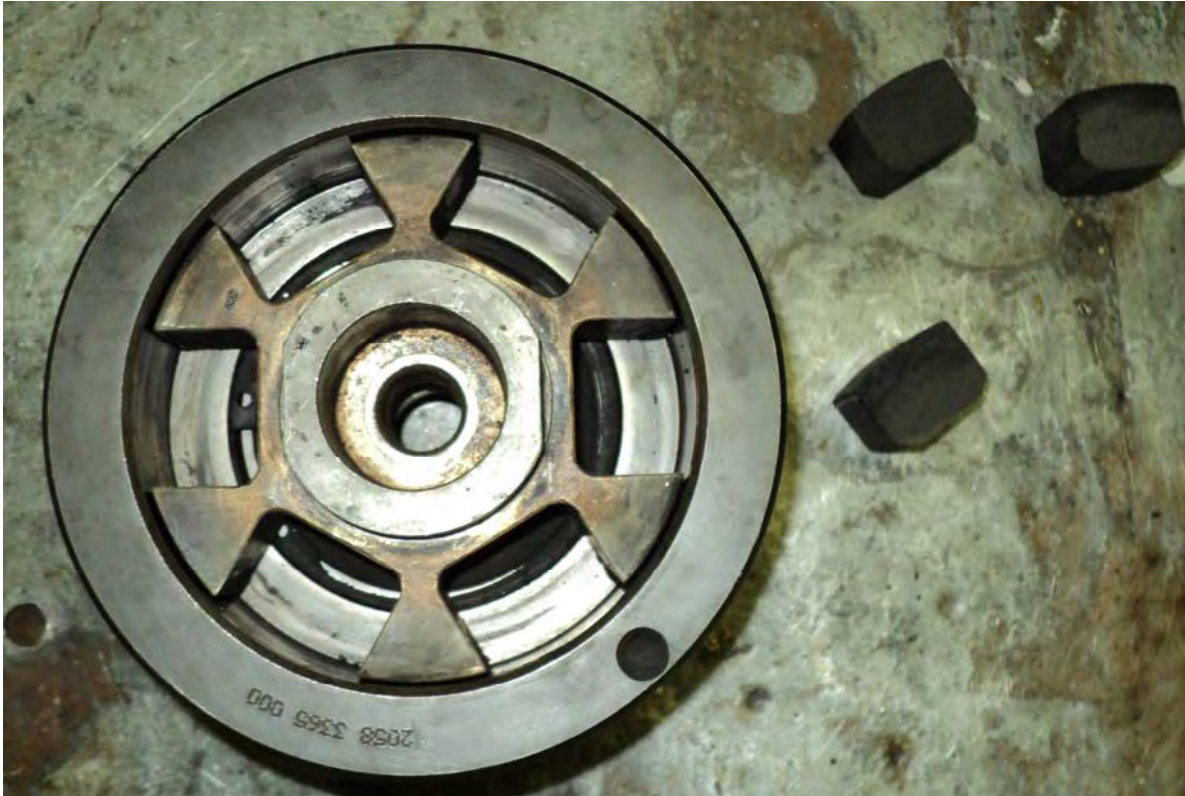
Рисунок 1. Загальний вид фрикційної муфти (фрикційні колодки демонтовані)
