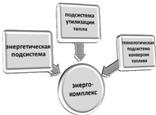
Рисунок 1. Структурная схема энергокомплекса с ТХР
