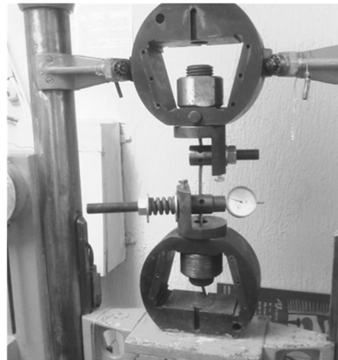
Рисунки 2. Дослідження зусилля закріплення каната на розривній машині УММ-5
