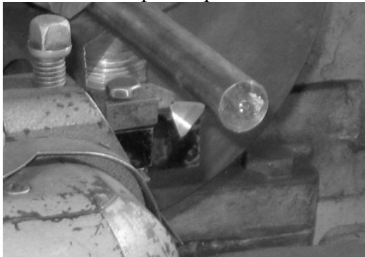
Рисунок 1. Відрізний різець з бічною установкою БНП
