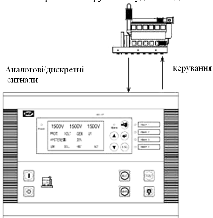
Рисунок 1. Схематичне зображення керування судновим дизель-генератором
