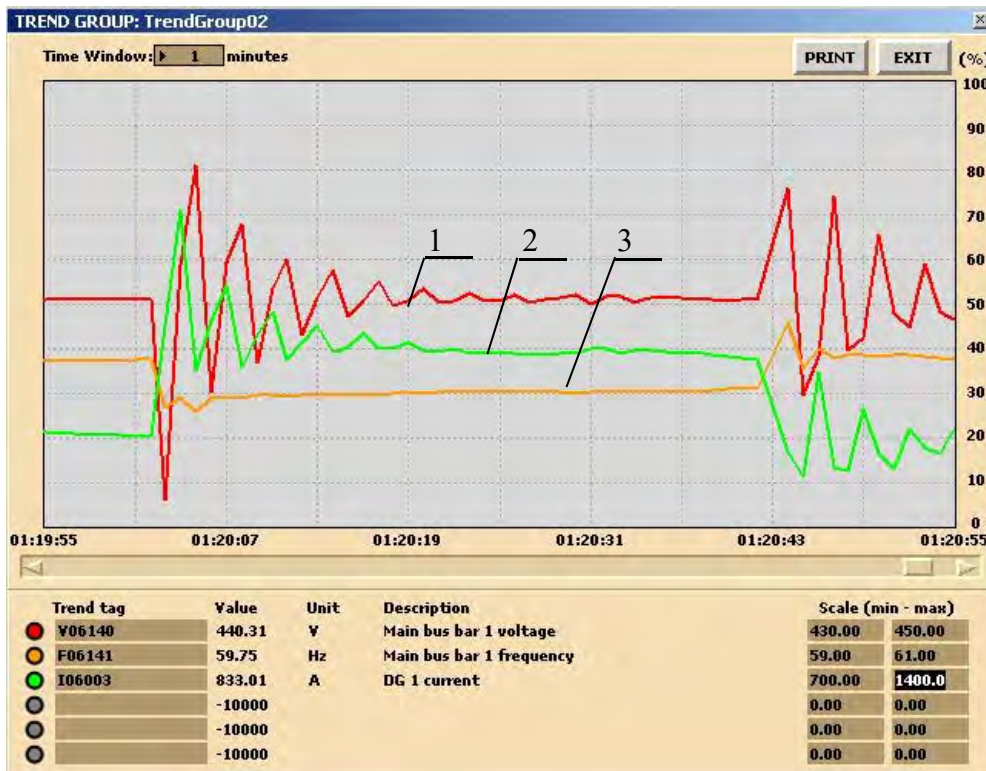
Рисунок 1. Осциллограмма при включении и отключении электродвигателя пожарного насоса
