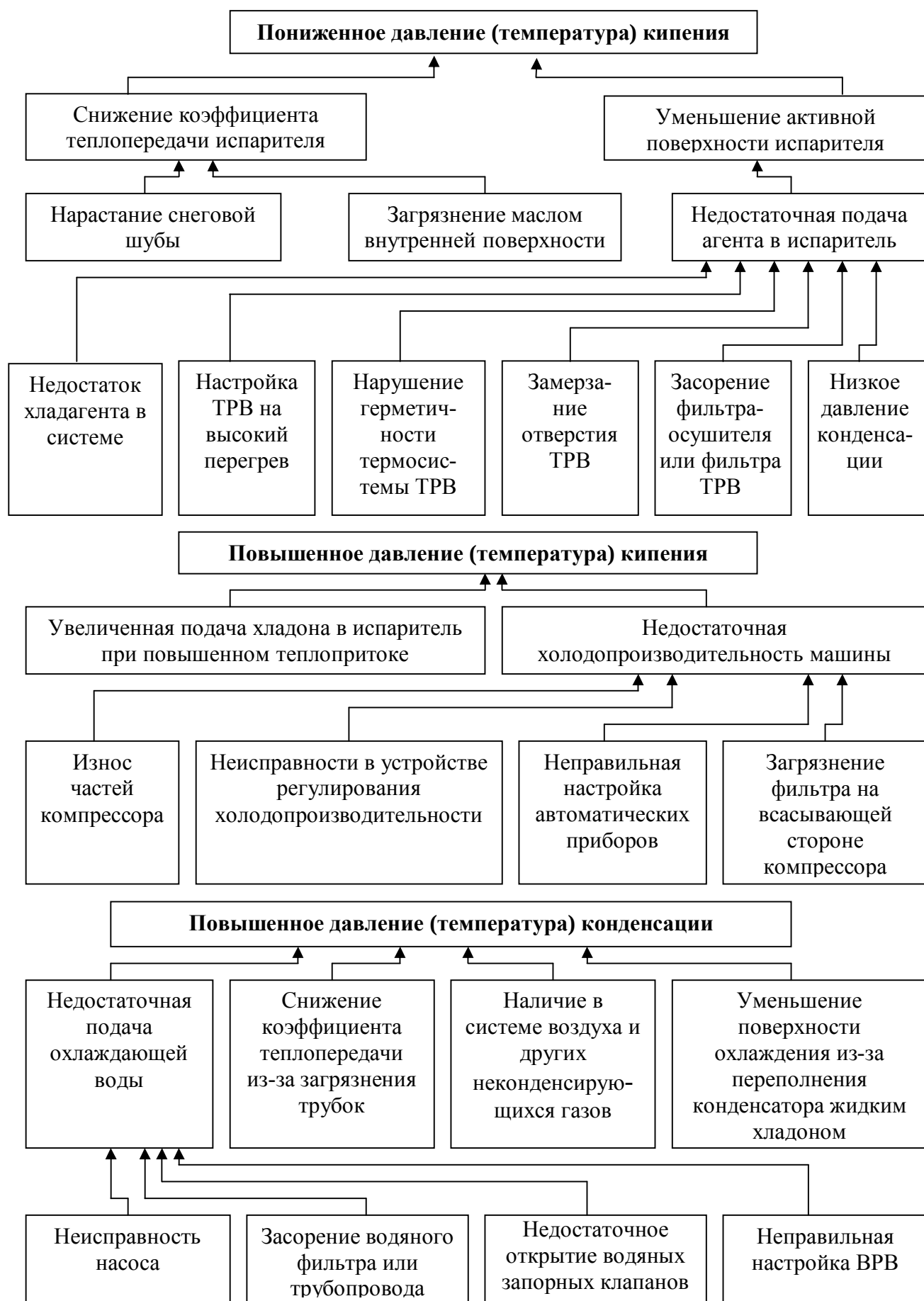
Рисунок 1. Причинные связи отклонения от нормы давлений (температур) кипения и конденсации
