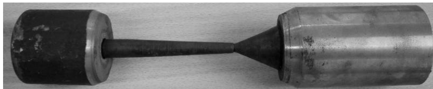
Рисунок 2 – Стальна загартована оправка для виготовлення сопла піскоструменевої машини промислового призначення
