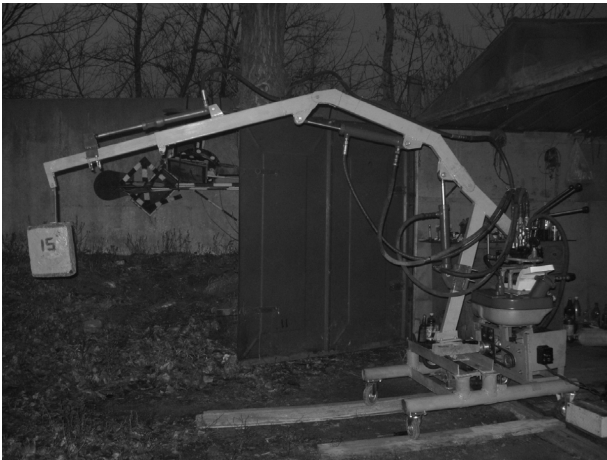
Рисунок 2 – Експериментальна установка крана-маніпулятора
