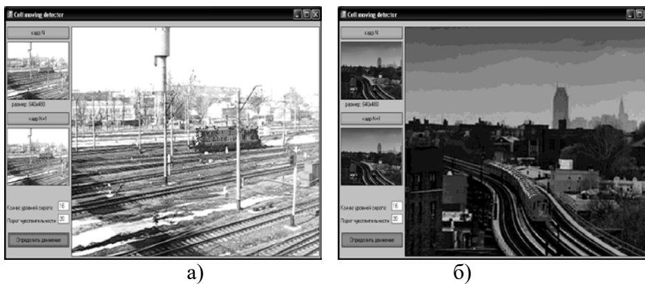
Рисунок 3 – Работа ПЭ с использованием порогового уровня для отсеивания «одинаковых» кодов серого оттенка
