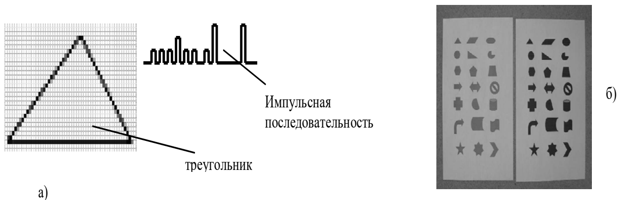
Рисунок 1 – Пример импульсной последовательности для треугольника – а) и примеры фигур, которые использовались в эксперименте – б)
