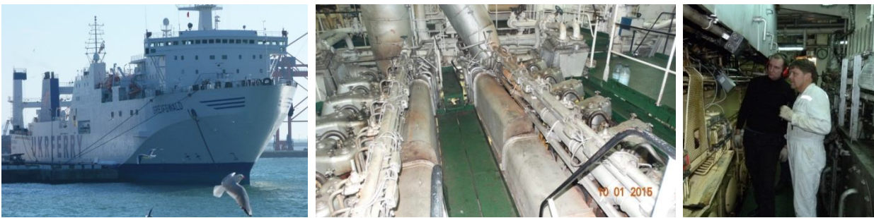
Рисунок 1 – Паром Greifswald: а) стоянка у причала в порту Самбул; б) вид с верхней платформы главных среднеоборотных дизелей 6VDS48/42AL-2U; с) индентификация главных дизелей системой D4.0H
