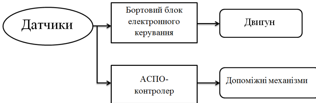
Рисунок 2 – Інформаційно-комунікаційна система транспортного засобу
