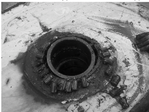
Рисунок 2 – Зруйнований роликівий підшипник канатного блока суднового палубного крану NMF DKII
