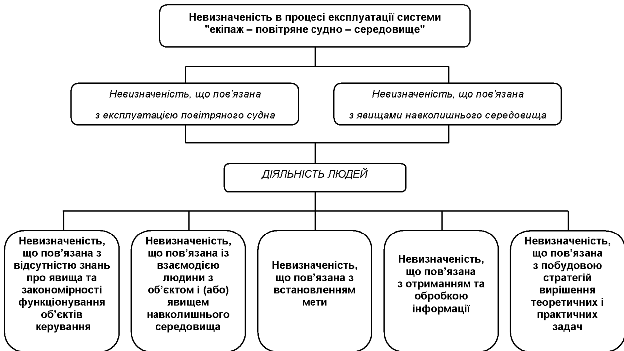
Рисунок 2 – Класифікація видів невизначеності, що виникають в процесі функціонування системи «льотний екіпаж – повітряне судно – середовище»
