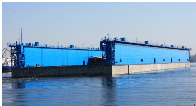
Рисунок 3 – Композитный плавучий док [3]
