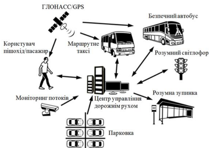
Рисунок 1 – Схема системи диспетчерського управління міським пасажирським автотранспортом
