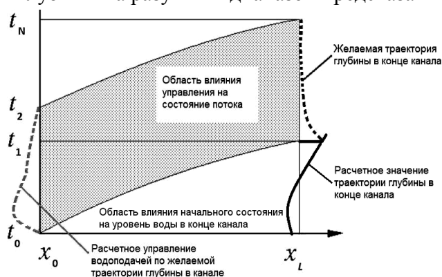
Рисунок 2 – Области влияния регулирующего сооружения на состояние потока воды в канале
