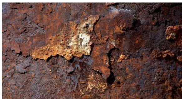
Рисунок 4 – Процесс окисления металлов в балластных отсеках
