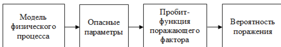
Рисунок 2 – Схема вероятностной оценки последствий аварии
