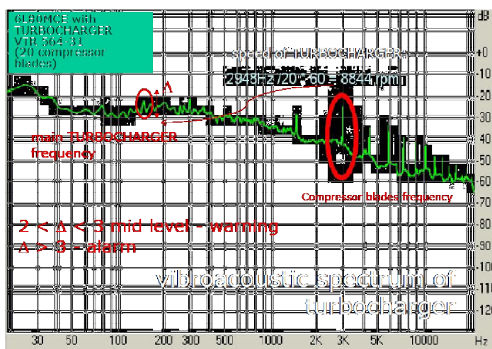
Рисунок 1 – Определение частоты вращения газотурбонагнетателя на эксплуатационном режиме с помощью спектрального анализа виброакустических сигналов компрессора
