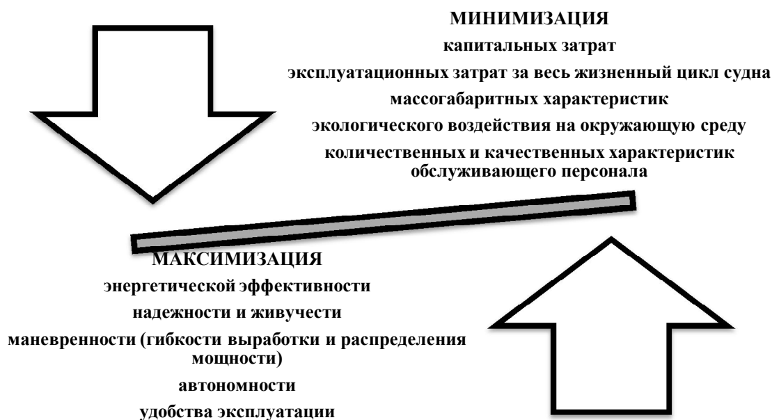
Рисунок 1 – Основные критерии выбора состава энергокомплекса транспортного судна
