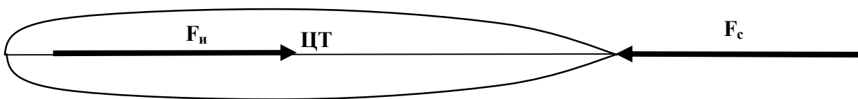
Рисунок 1 – Судно движется прямолинейно по инерции
