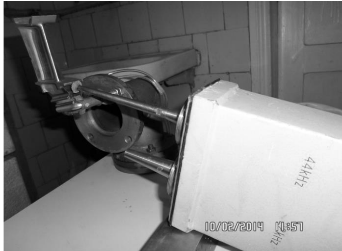
Рисунок 1. Фрагмент стану з активуючого нагріву лопатки ГТД джерелом ультразвукового випромінювання
