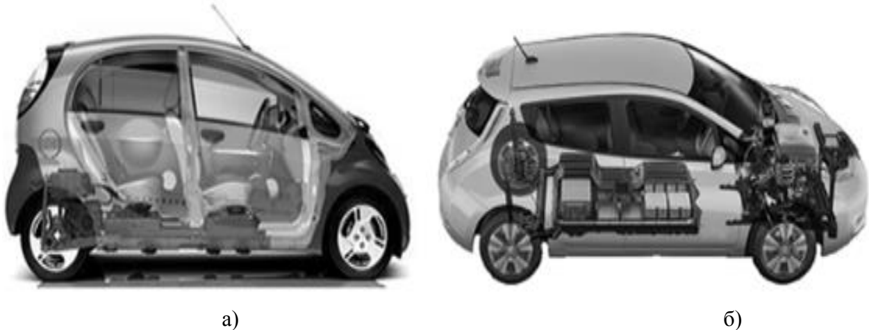
Рисунок 1. Схеми двох відомих чистих електромобілів, що показують положення основних силових пристроїв: акумуляторів, інвертора і електричної машини, (а) задній привід і (б) передній привід
