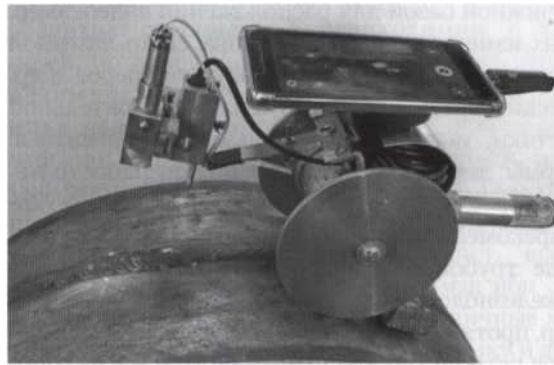
Рисунок 3 – Прилад в процесі запису на зварювальному шві обичайки діаметром 1020 мм газової турбіни, за допомогою якого фіксуються нерівномірності зварювального шву, підрізи і пори, які виходять на поверхню
