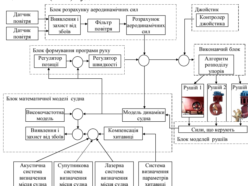
Рисунок 1 – Схема керування системою динамічного позиціонування (SDP)
