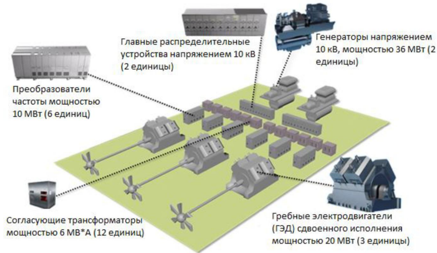
Рисунок 1 – Электроэнергетическая пропульсивная установка атомного ледокола
