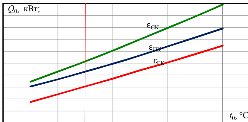
Рисунок – 2 Зміна коефіцієнта холодопродуктивності компресорів в залежності від температури кипіння
