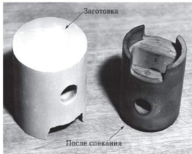
Рисунок 3 – Поршень ДВЗ із щільноспеченого нітриду кремнію
