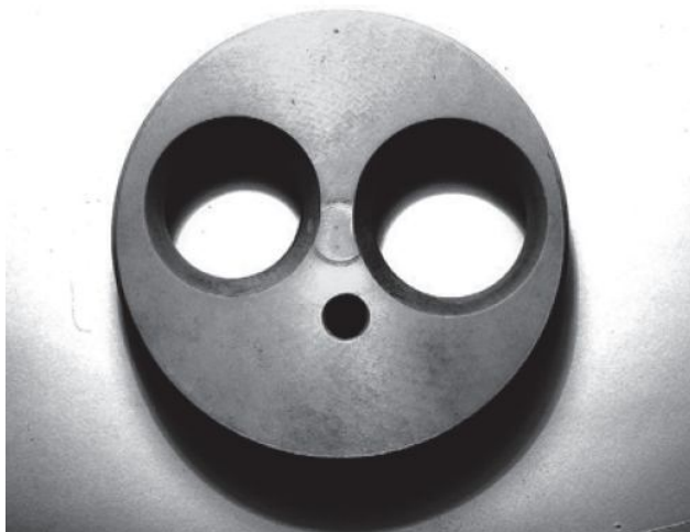
Рисунок 4 - Голівка циліндра з титанату алюмінію
