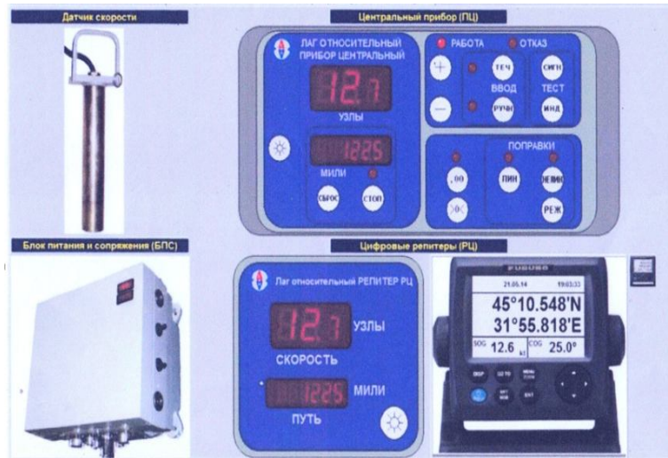
Рисунок 2 – Індукційний лаг ІЕЛ-3: Датчик швидкості (ІППС); Блок живлення (БПС); Центральний прилад (ПЦ); Цифрові репітери (РЦ)
