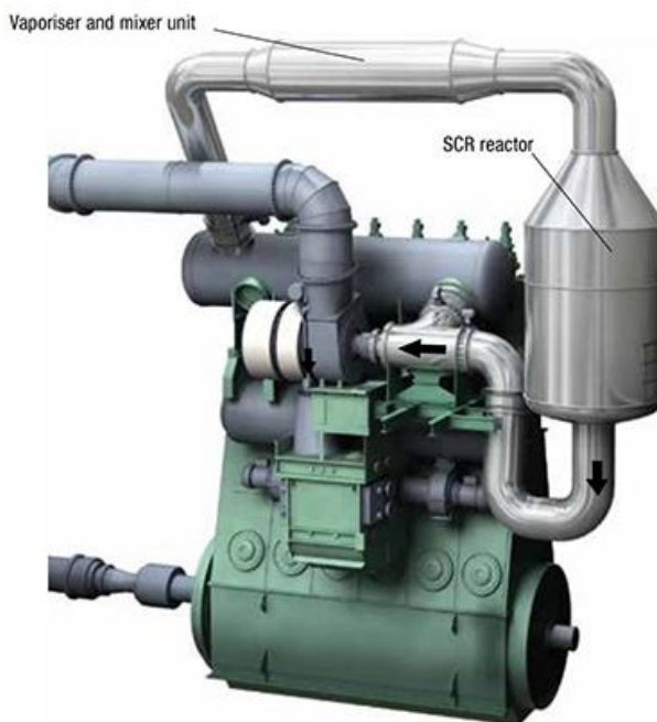
Рисунок 2 – SCR – система, встановлена на двигуні MAN B&W [3].
