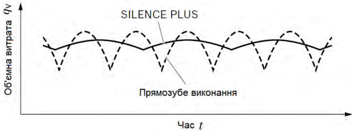
Рисунок 2. Нерівномірність подачі робочої рідини
